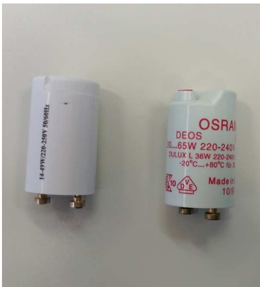
Kuva 7. Oikealla syytin loisteputkivalaisimeen, vasemmalla sulake T5-adapterille.
