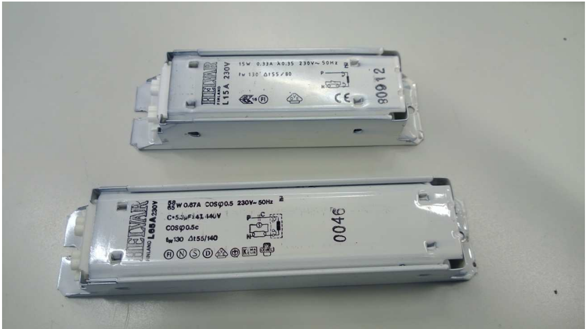
Kuva 6. Magneettisia kuristimia loisteputkivalaisimiin.
