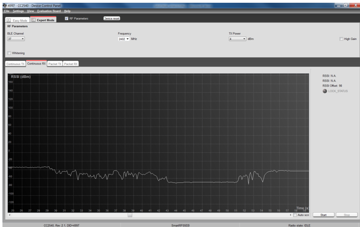
KUVA 23. SmartRF Studio ohjelmalla tehty signaalinvoimakkuus mittaus
