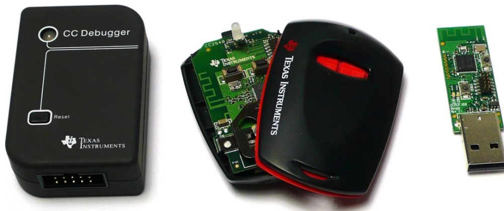
KUVA 26. CC2540DK-MINI kehitysalusta pakkauksen sisältö. Kuvassa vasemmalla kehitysalustan ohjelmointiin käytettävä CC Debugger, keskellä BLE-moduuli sekä oikealla USB-dongle
