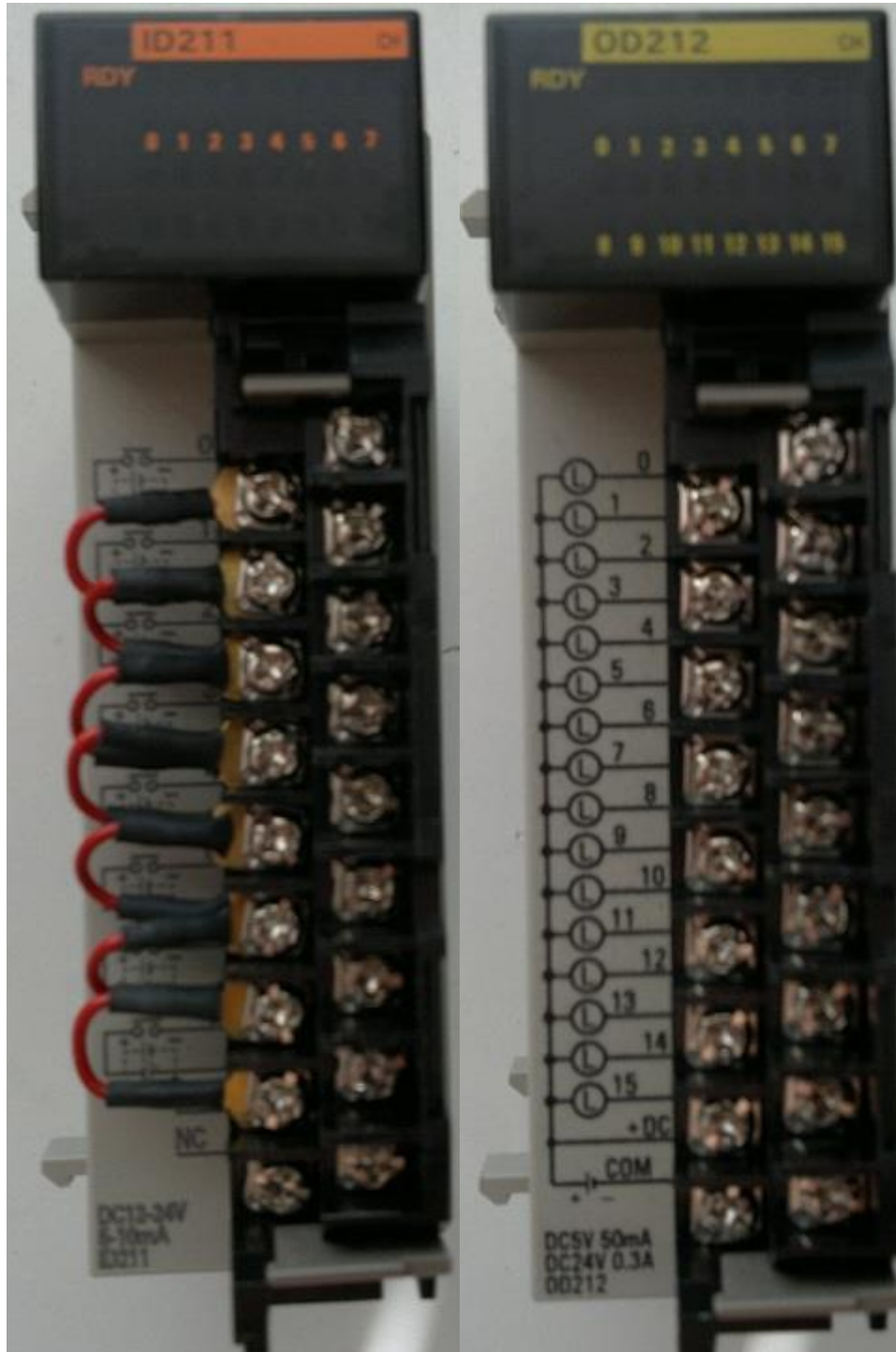
KUVIOT 3 & 4. Vasemmalla kuviossa 3 ID211 lisäyksikkö, joka sisältää 8 tuloliitintää. Oikealla kuviossa 4 OD212 lisäyksikkö, jossa on 16 lähtöliitintää.
