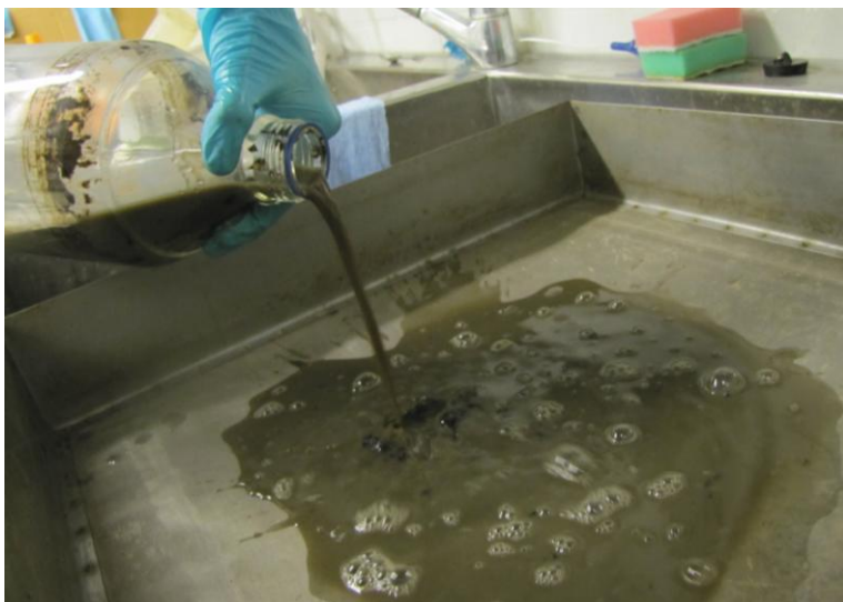
Figur 32. Tömning av TR2 14.8.2012. Innehållet hålls ut över ett filter, där det fasta materialet lämnar och tas tillvara, vilket fungerar som avvattningsmetod.
