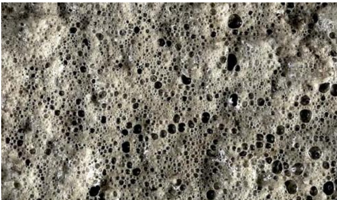
Figur 6. Bild av hur metastabilt skum kan se ut i en reaktor (Herbes, Moeller, Müller & Zehnsdorf, 2010, s. 204).
