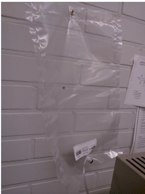
Figur 29. Påse (Tedlar Bags) för gasuppsamling vid försöken, slangen leder från de genomskinliga testreaktorerna.
