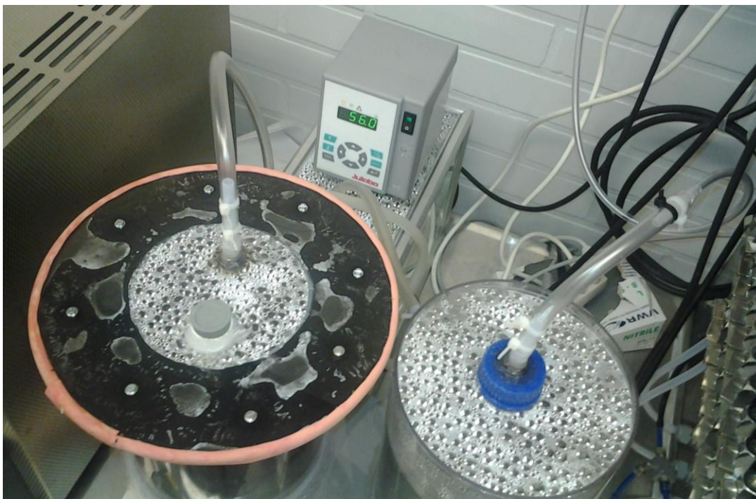
Figur 28. Uppställningen med vattenkäril och uppvärmningspump bakom genomskinliga rötreaktorer.
