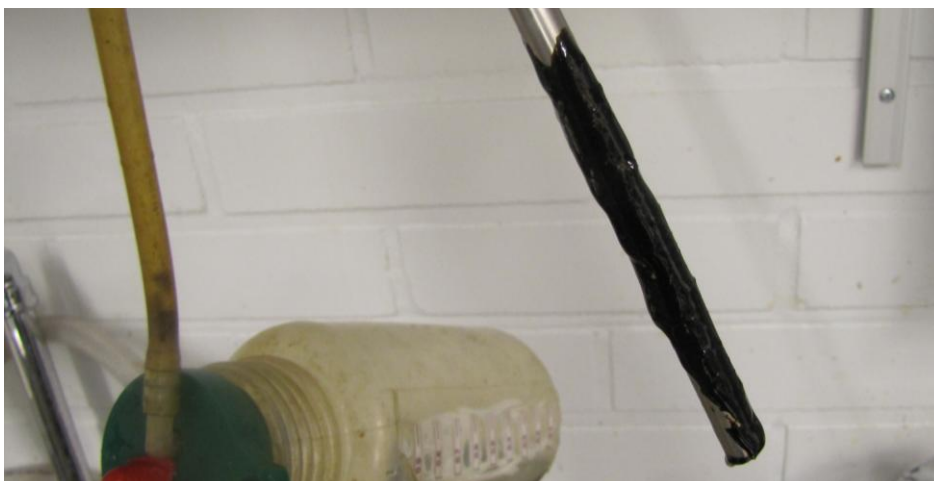
Figur 33. Slamtäck som uppstått i de båda testreaktorerna, främst i TR1, har smutsat ner provtagningsutrustning (foto taget 14.8.2012). Slammet är fett och svårt att få bort.
