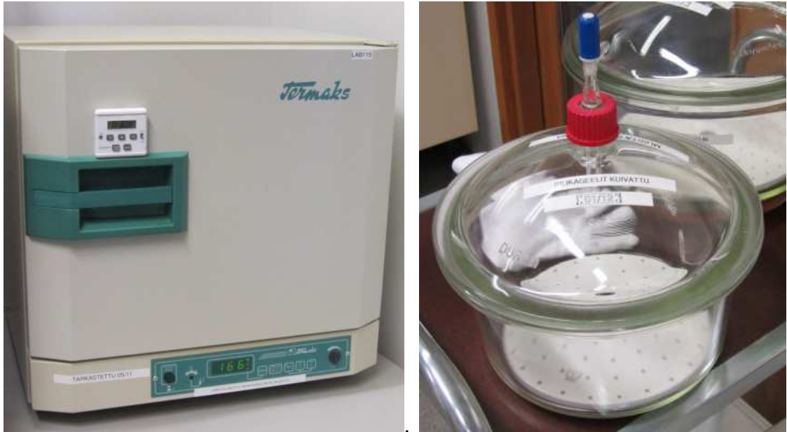
Kuva 16. Termaks-lämpökaappi ja eksikaattori
