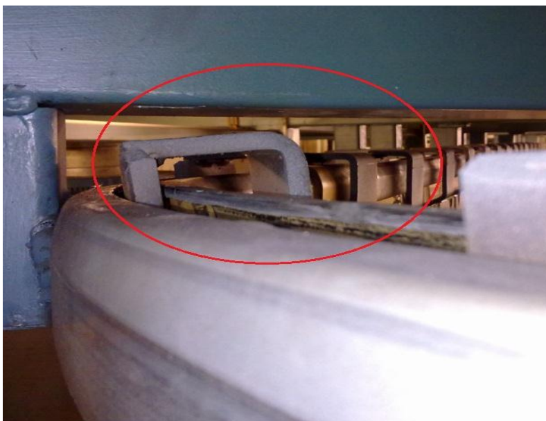
Kuva 19. Kuormavaunun vääntyminen mutkissa.
