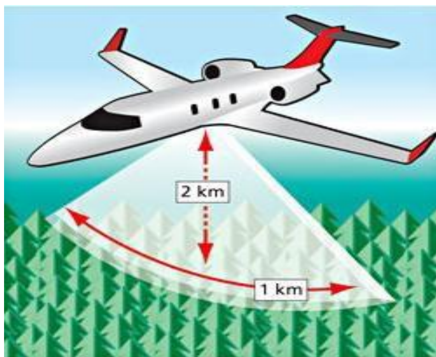
Kuvio 2. Laserkeilausmittauksen periaate. Kuva: Bange Design
