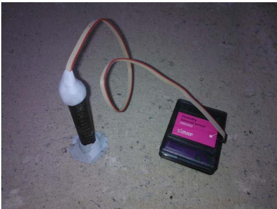
Figur 35. Simap-sond placerad i ett 16 mm Vaisala mätrör på djupet 35 mm.
