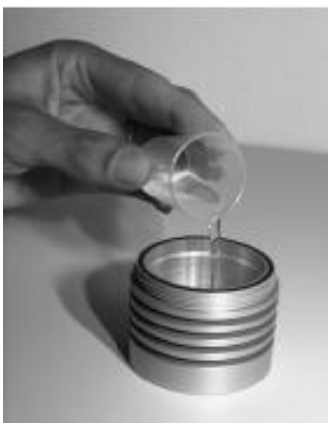
Figur 9. Ställ kammaren på ett bord. Häll jonfritt eller destillerat vatten i kammaren. Korrekt mängd anges i tabell 2. Skölj och torka av mätkoppens efteråt med papper. 37
