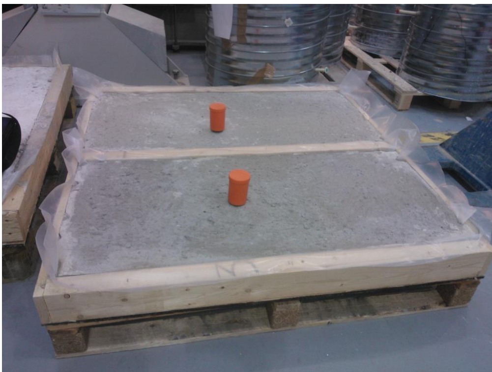
Figur 26. Vaisalas skyddsburkar med mätrör och mätprob inuti, placerade på betongplattorna.
