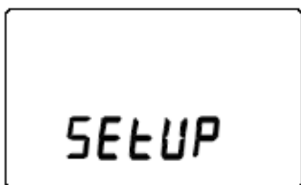
Figur 15. Släpp därefter ON/OFF-knappen och tryck inom 1–2 sekunder samtidigt in både ENTER och MODE, tills följande kan läsas på displayen.
