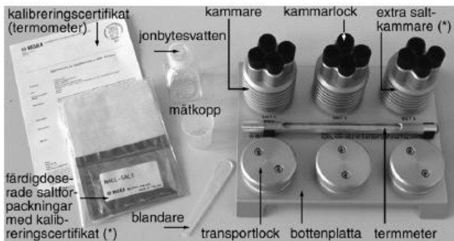
Figur 7. Fuktkalibrator HMK15 (längst till höger) med tillbehör. 36
