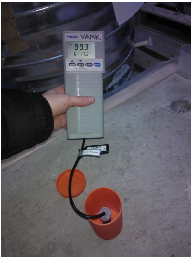
Figur 28. Fuktmätning av betongplattorna. Mätprob HMP44 fastkopplad till indikator HMI41 för avläsning av mätvärden.
