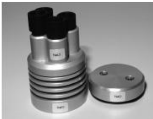
Figur 12. Anteckna på en etikett när saltlösningen är gjord och sätt etiketten på kammaren. Använder man sig av fördoserade saltförpackningar kan man använda sig av deras etiketter (t.ex. NaCl) och klistra fast på kammare, kammarlock och transportlock enligt bilden.
