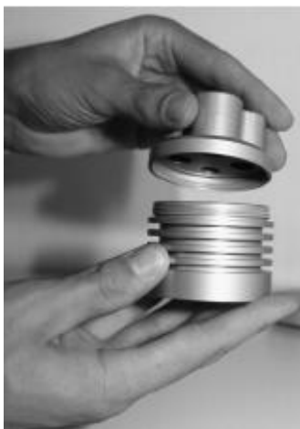
Figur 11. Kammaren försluts sedan med kammarlocket ifall man har för avseende att kalibrera inom kort och med transportlocket ifall kammaren kommer att stå länge utan att användas.
