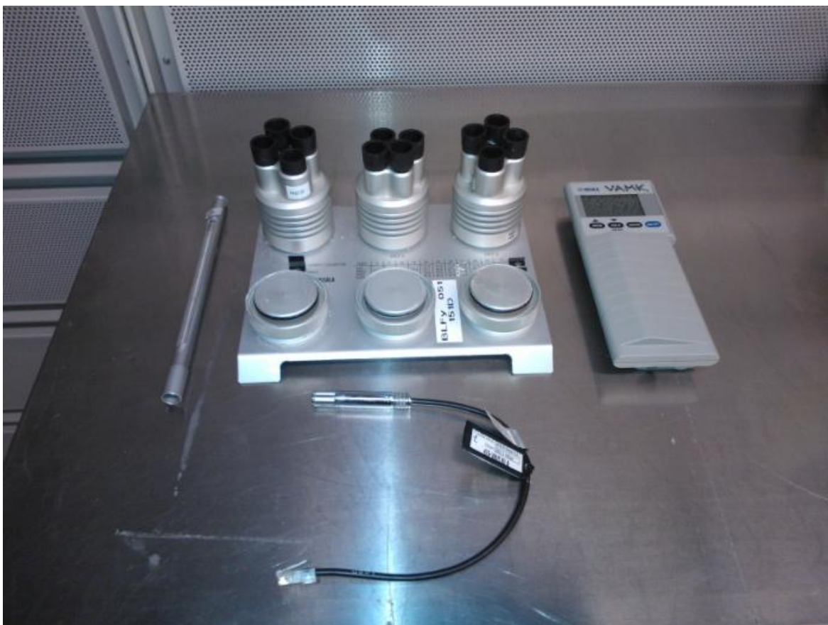
Figur 6. På bilden kan ses temperaturmätare längst till vänster, fuktikalibrator HMK15 i mitten, indikator HMI41 längst till höger och en mätprob (HMP44) längst fram. Dessa instrument behövs vid kalibreringen.
