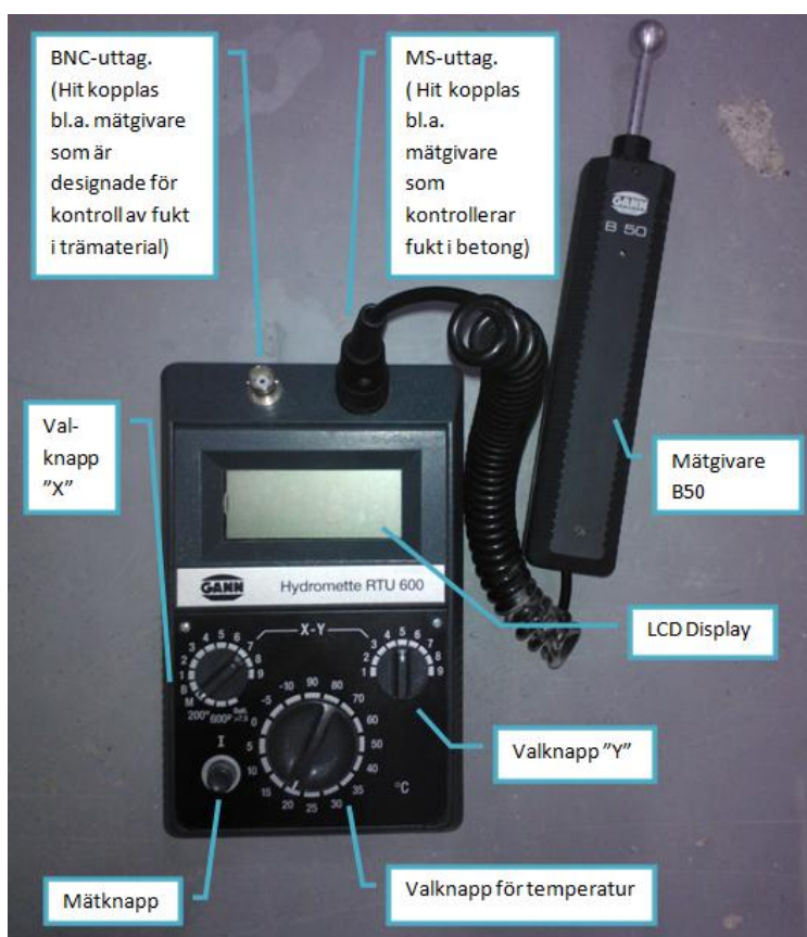
Figur 4. Ytfuktmätare Gann Hydromette RTU 600 med mätgivare B50 fastkopplad. Namnen på mätinstrumentets olika delar finns i Gann-manualen. 21
