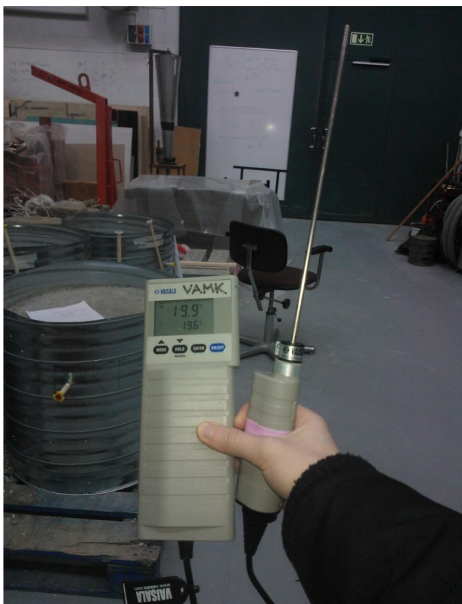
Figur 27. Kontroll av inomhusluftens relativa luftfuktighet och temperatur i byggnadslaboratoriet i Technobothnia. Denna mätning genomfördes varje gång probernas värden avlästes.
