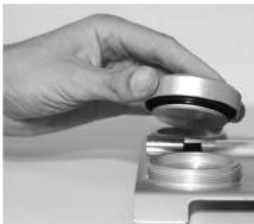
Figur 8. Ta bort kalibratort från förpackningen. Ta bort kalibratortens transportlock. Ta av mätlocket från kammarens hållare och skruva fast transportlocket på bottenplattan.
