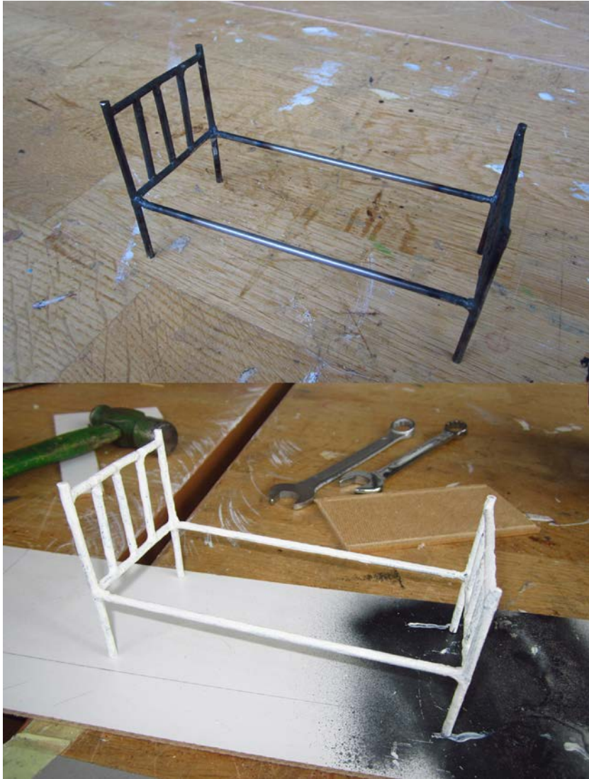
Kuva 22. Maalaamaton ja maattattu sängyn runko.
