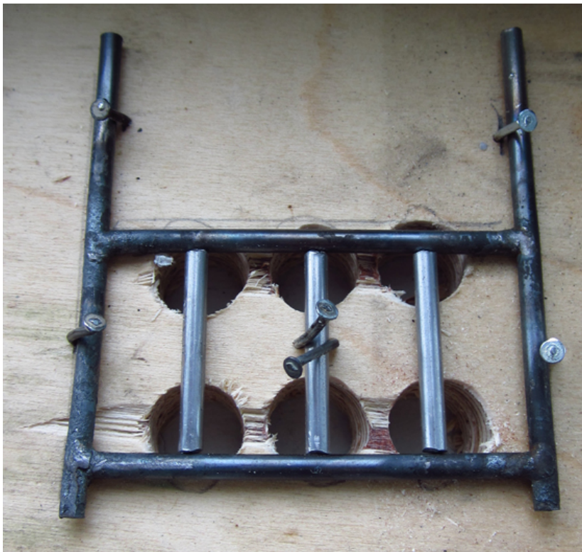
Kuva 19. Ohuiden juotoslankojen tilalle vaihdettu paksummat, 3mm
