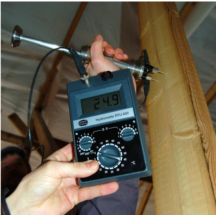
KUVA 9. GANN Hydromette RTU 600 ja piikkianturi M18
