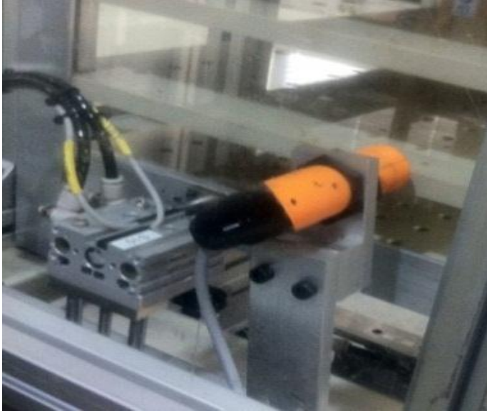
Kuva 22. Palettien loppumista vahtiva kapasitiivinen anturi
