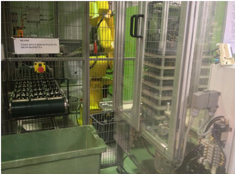
Kuva 11. Robotin hätä-seis-nappi sijoitettuna laitteen lähelle.
