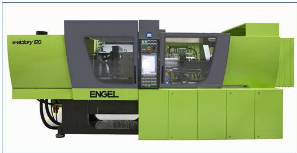
Kuva 8. Nykyaikainen ruiskuvalukone Engel e-Victory 120. (Engel 2013)
