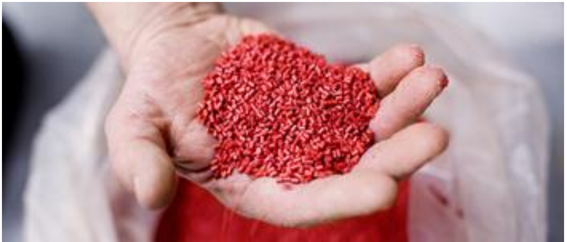
Kuva 5. Muovin raaka-aine eli granulaatti. (Primo 2013)
