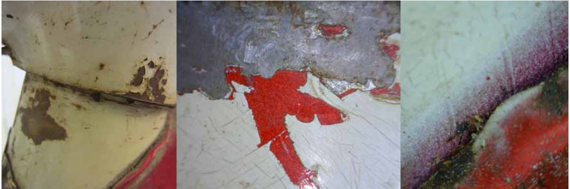
Kuvat 18–20. Ohjaustangon alakotelon ja etukotelon vaurioita, punainen kalvo etukotelon vaalean pinnan alla, etukotelon ja tankin rajakohta
