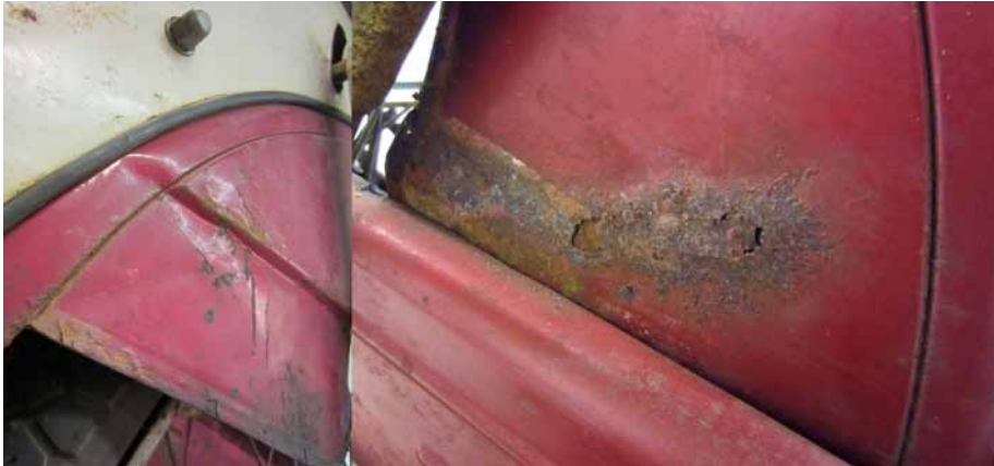
Kuvat 33–34. Takalokasuojan vasemman sivupellin lommoutuma ja oikean sivupellin korroosio ja nirhauma
