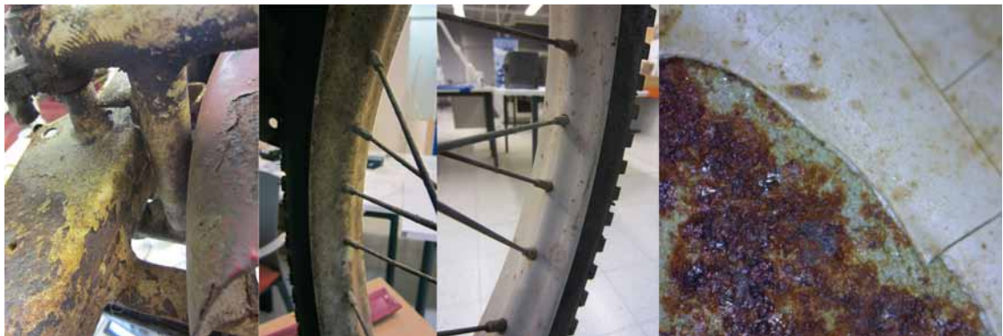
Kuvat 25–28. Likaisen alaosan pitkälle edennyt korrosio, taka- ja etuvanne, takavanteen vihreä pohjamaali ja korroosiota
