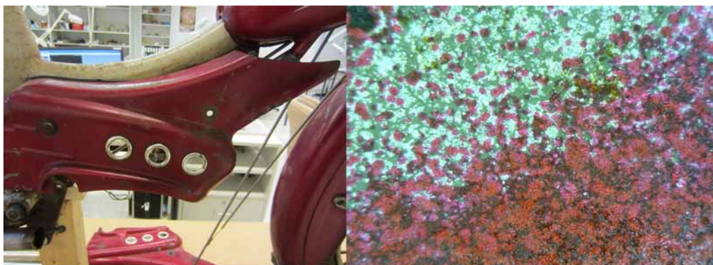
Kuvat 39–40. Oikean puoleinen moottorikotelo ja sen sisäpuolelta otettu mikroskooppikuva, jossa näkyy pohjamaalin päälle ruiskutettua metallimaalia, punaista kuultolakkaa ja pintalakkaa
