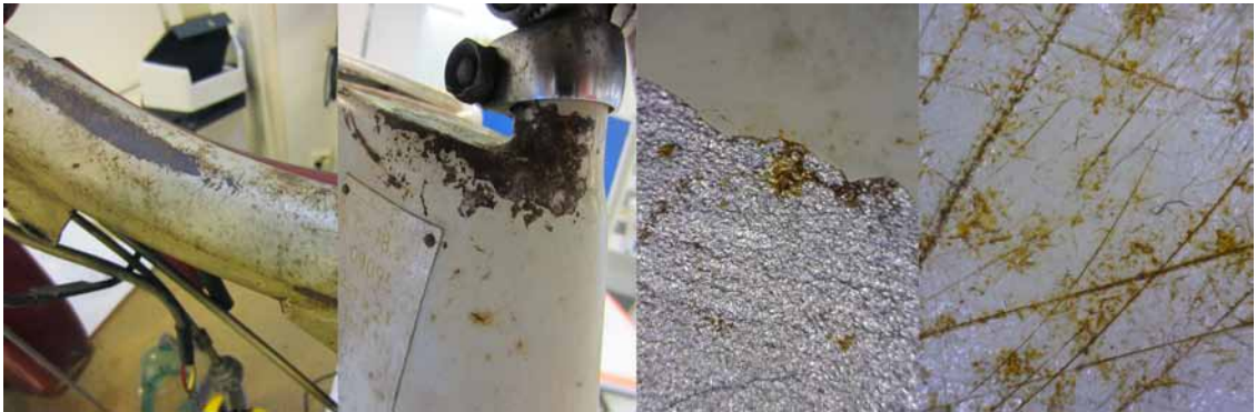
Kuvat 14–17. Runkoputkea, satulanalus, rungon vaalean maalikalvon alta paljastunut metallinen pohja, takakoteloinnin korroosion värjäämää ja naarmuttunutta pintaa
