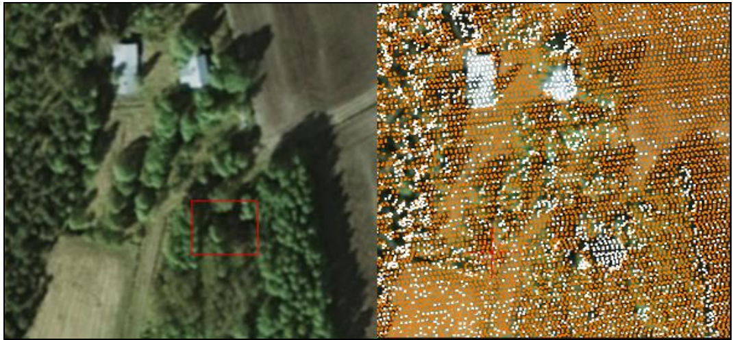
KUVA 34. Rakennuksen digitointi pistepilven avulla
