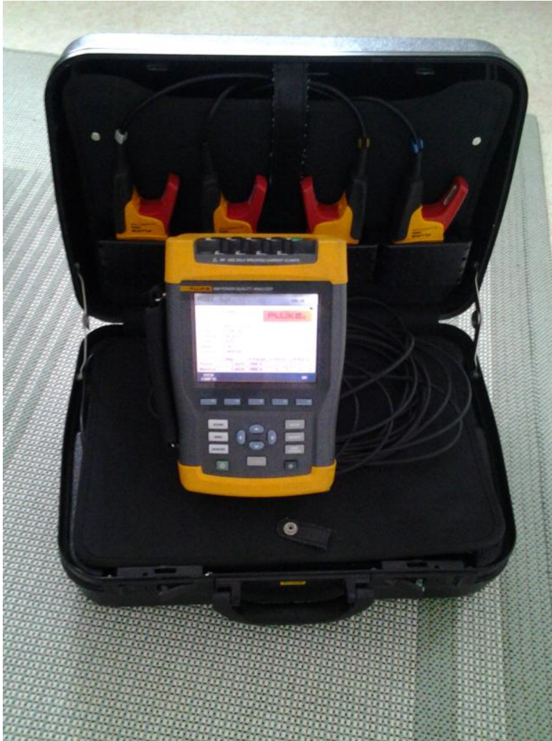
KUVA 7. Fluke 434 sähkönlaatuanalysointilaitteen lisälaitteineen. Kuva Mikko Karvonen 2013
