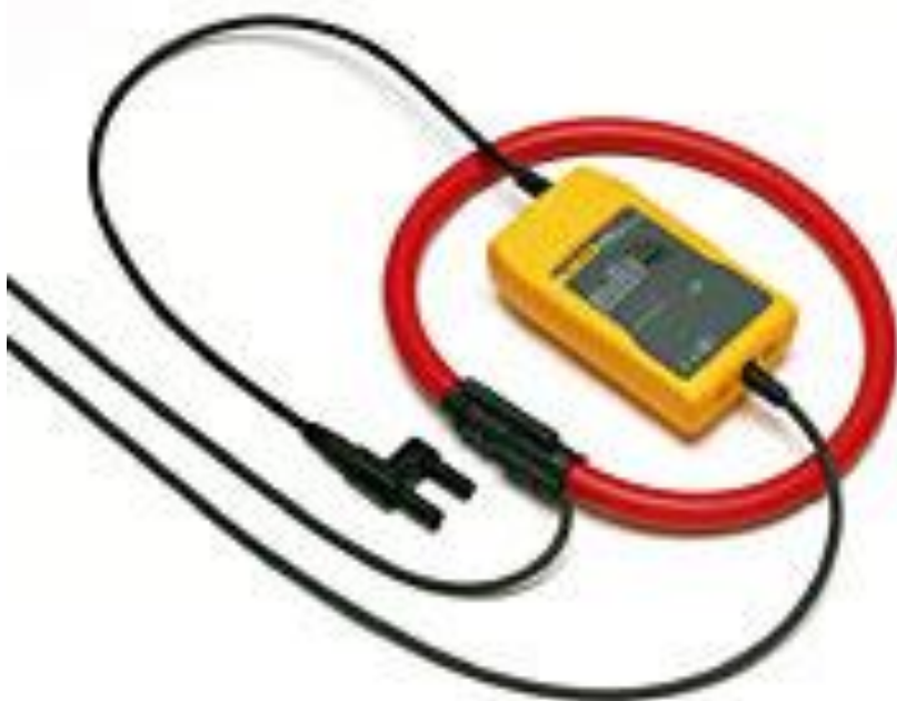
KUVA 8. Fluke i2000-FLEX kestää 2000 ampeeria ja tarvitsee erillisen 9 voltin patterin toimiakseen (Fluke 2013b.)
