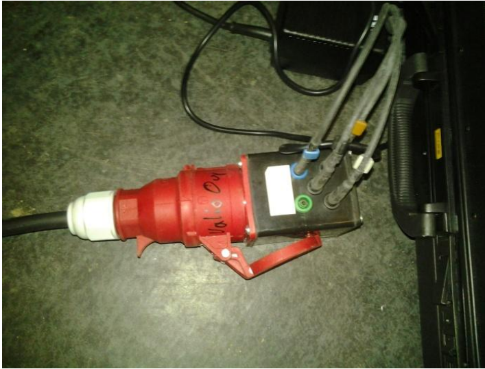
KUVA 9. Jännitemittausta helpottava liitin. Kuva Mikko Karvonen 2012.
