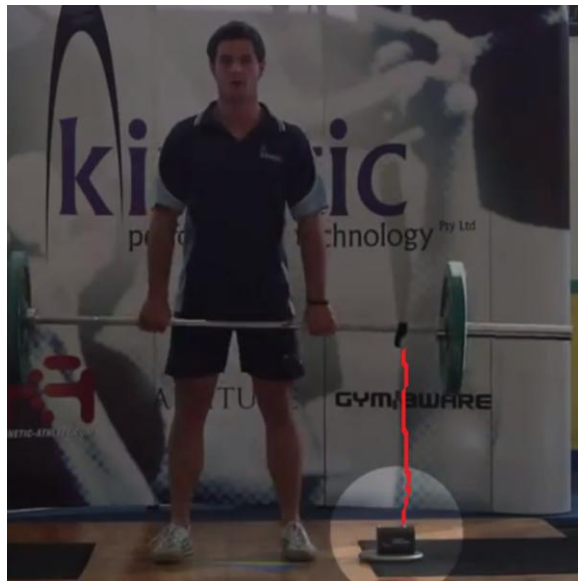
Kuva 9. Powertool kiinnitettynä levytankoon, kaapeli korostettuna punaisella. [6.]
