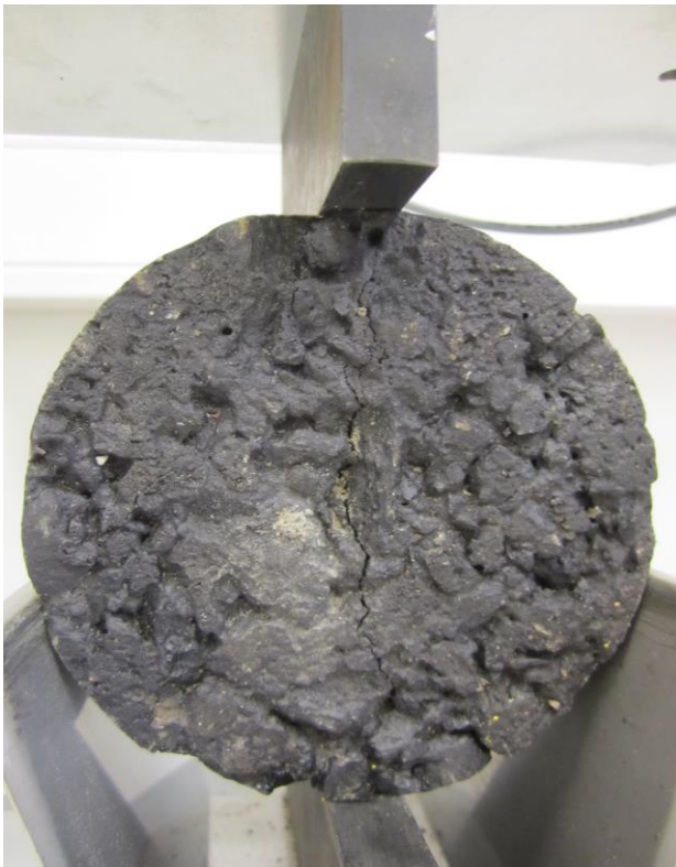
KUVA 10. Koekappaletta kuormitettiin murtumiseen saakka
