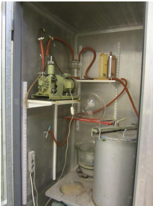
KUVA 6. Laitteisto, jolla koekappaleet alipaineistettiin ennen vedenkestävyydestä sekä jäätymis-sulamiskestävyystestiä
