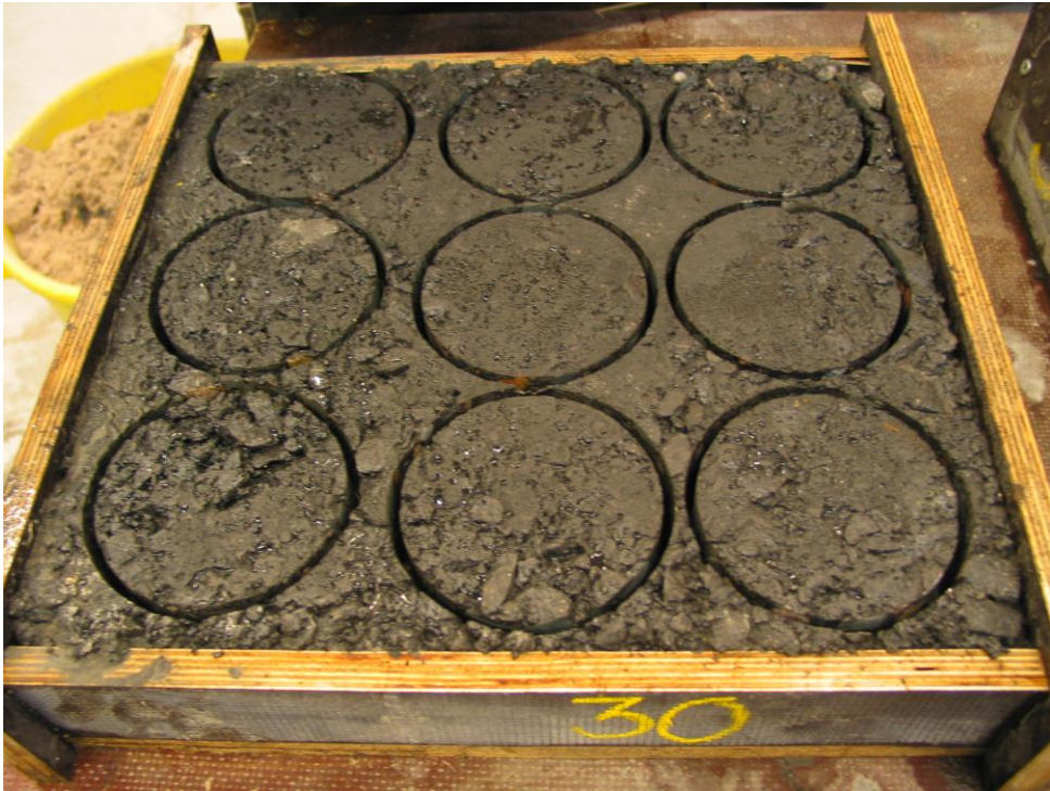
KUVA 2. Laatta AB16RC30, josta on porattu 9 koekappaletta
