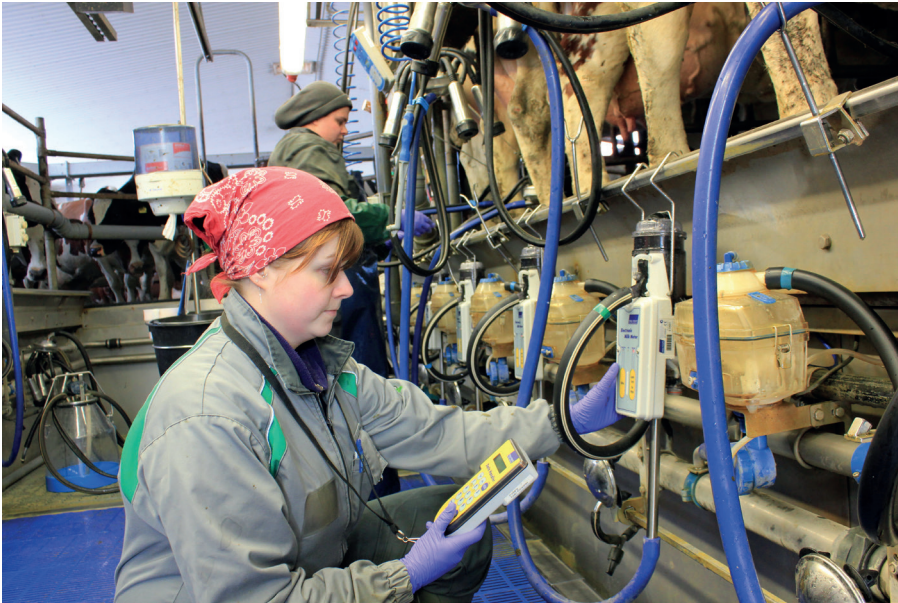
KUVA 2. Lehmän korvanumero syötetään EMM-mittarille Data Handlerin avulla. (Kuvaaja: Anna-Riitta Leinonen, ProAgria Keski-Pohjanmaa)
