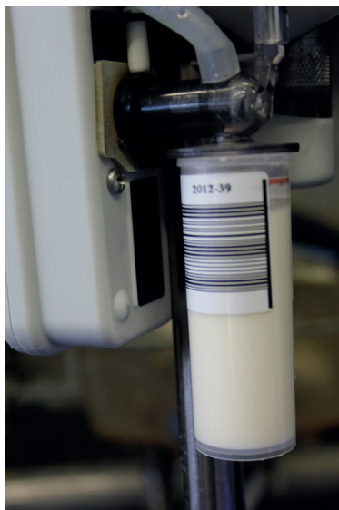
KUVA 1. EMM-mittari annostelee maitonäytteen automaattisesti viivakoodipulloon. (Kuvaaja: Anna-Riitta Leinonen, ProAgria Keski-Pohjanmaa)
