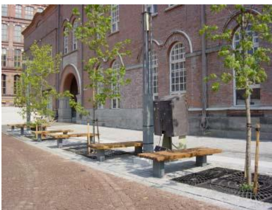
KUVA 31. Penkeille, istutuksille ja pylväille on varattu oma kaistansa katutilasta (Frenckellin aukio. Tampere; Tampereen keskustaalueen esteettömyyssuunnitelma 2005)
