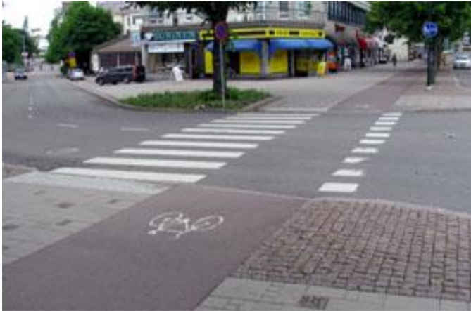
KUVA 45. SuRaKu-ohjeistuksen mukainen esteettömyyden erikoistason suojatie ylittää Oikokadun Kouvolankadun liittymässä Kouvola. Pyörätien ja jalkakäytävän erottelu on toteutettu erilaisella ja erivärisellä päällystemateriaaleilla liikennemerkkien lisäksi (Kouvolankatu, Kouvola)
