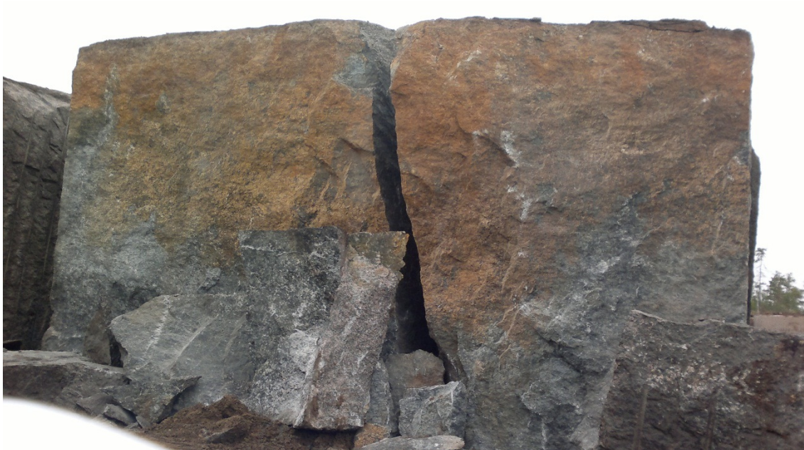
Kuva 10 . Rakopinta 8,5 m kohdalta on ollut yläosastaan avoin. Ruosteen väri on pintaveden aiheuttamaa, muu osa rakopinnasta tummien mineraalien peittämää, samoin pitkittäisraon pinnat. Pitkittäinen rakopinta kaatuu etuseinään päin, matka etuseinästä ylhäällä 4,2m, alhaalla 2,9m. Pitkittäisrako jatkuu seuraavaan poikkirakoon 13.8m saakka. Oikea puoli meni rikoksi rakojen ja värivirheen vuoksi. Vasemmalta puolen saatiin kaatolohkare väliltä 11,8- 13,8 takaseinästä rakopintaan saakka. Tässä näkyvästä pinnasta em. kaatolohkareeseen asti kivessä oli yläpinnalla nähtävissä kaksi kamaa viistosti leikkaavaa rakopintaa (toisessa ”musta nauha”), joiden vuoksi tämä osa meni rikkokiveksi.
