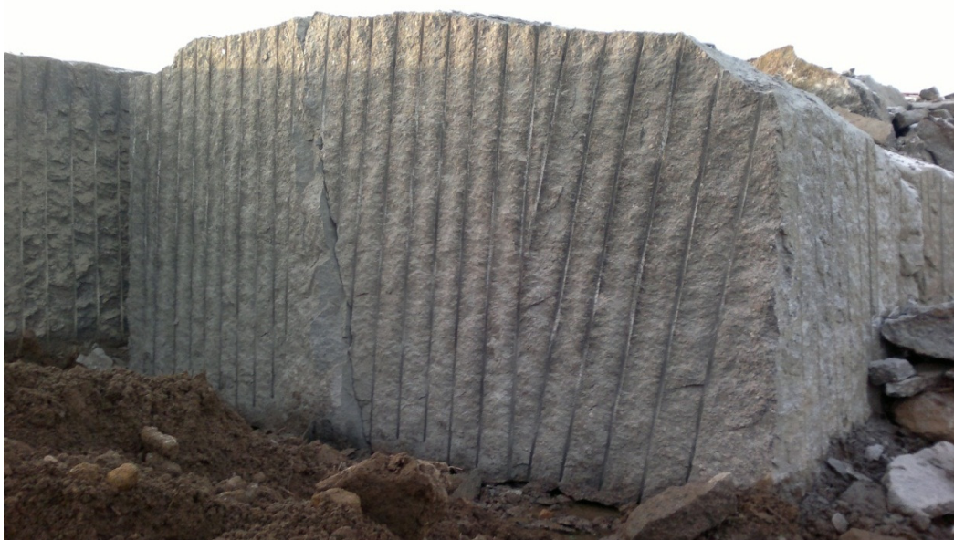
Kuva 21. Kamin paloittelu on edennyt kohtaan n. 30 m. Kamin pinnalla räjäytyksen jälkeen havaittu rako on tässä näkyvissä. Raon kaade on noin 70 astetta ja kaateen suunta kamin etureunaa kohti.
