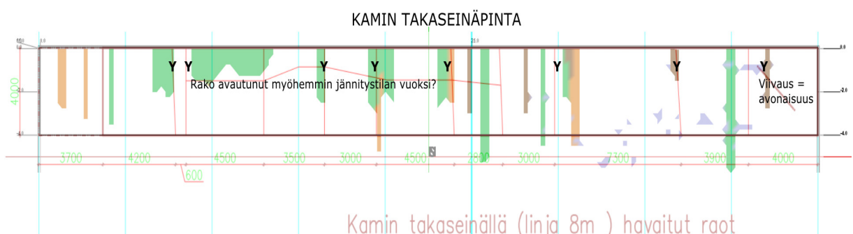
Kuva 4.4. Kamin takapäädyn pystypinta, todetut viat ja mallin leikkaus (katselusuunta kamin sisältä ulos).
