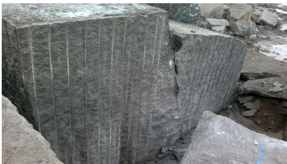
Kuva 22. Kamin paloittelu on edennyt kohtaan 32,5 m alusta. Pysty pituussuuntainen rakopinta, jonka kaade on n. 75° etuseinään päin, halkaisee kamin loppuosan. Rakopinnan sijainti kamin pinnalla oli 3,1 m takaseinästä ja pinnalla oli nähtävissä rako välillä 25-45 m. Yläreunassa 1,8 metrin päässä takaseinästä on näkyvissä myös
