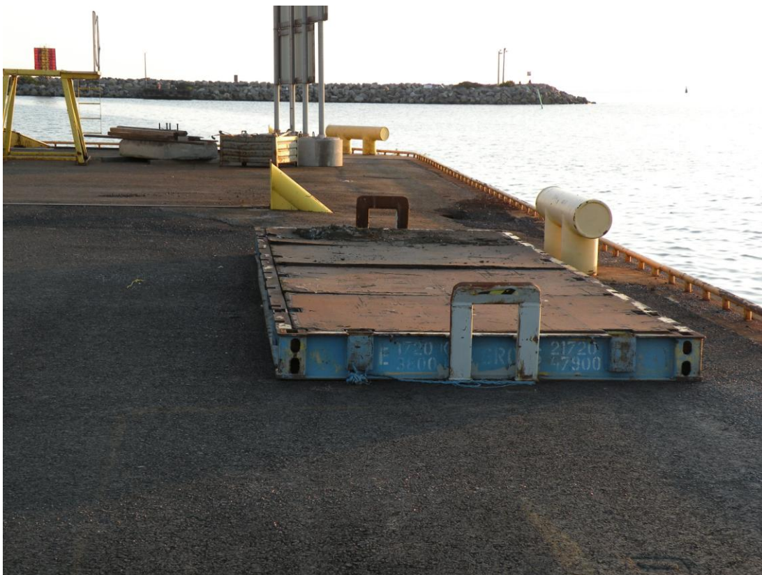
Kuva 2. Räjähteille tarkoitettu alusta.
