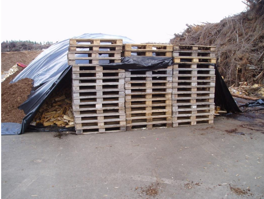
Kuva 5. Toisen kuivausauman ilmanottopäät
