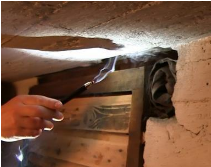
Kuva 17. Savu imeytyy kellarin keskikäytävästä keskimmäiseen kellarihuoneeseen ja sitä kautta sisälle taloon.
