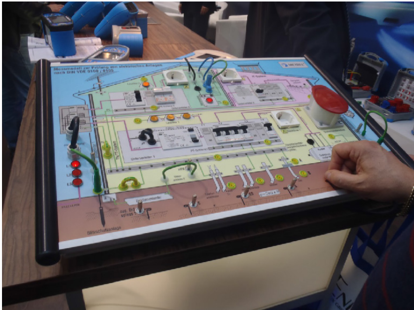
Kuva 15. Kiinteistösähköistystoimintojen mittaus- ja käyttöönoton demonstraatiolaitteisto (Metrel).
