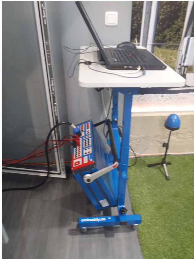
Kuva 8. Omicron relekoestuslaitteen pöytäteline, kyseinen relekoestuslaite on hankittu sähkövoimatekniikan laboratorioon.
