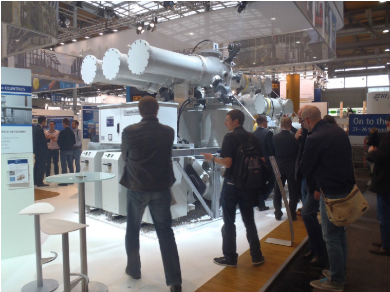
Kuva 5. Toisen valmistajan 110 kV SF-kojeisto.
