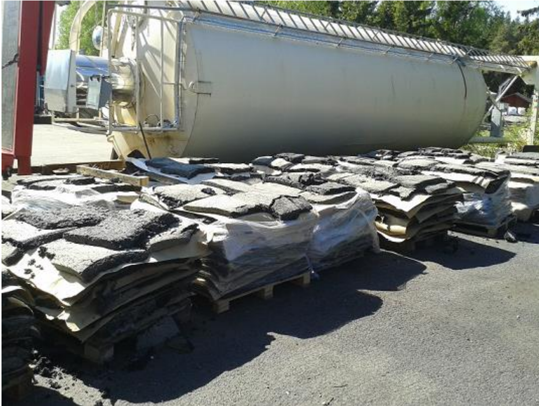
KUVA 9. AB-paikkausmassa varastoja kesän paikkauksia varten
