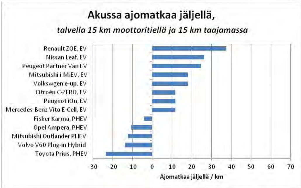
Kuva 28: Sähköauton akku yhden talvisen toimintamatkan jälkeen
