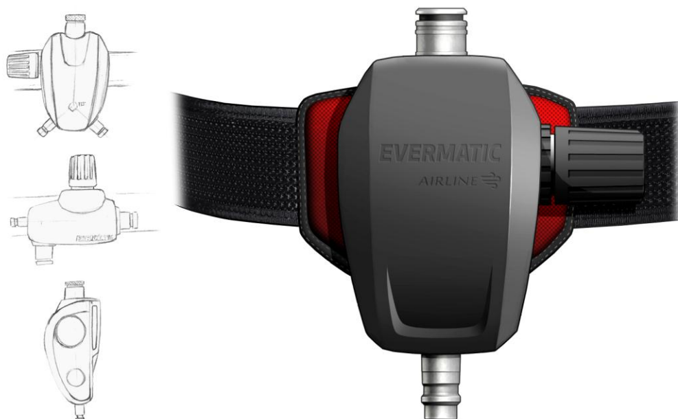
Kuvio 10. Luonnoksia ja oikealla jatkokehitykseen valittu luonnos paineensäätimestä.
