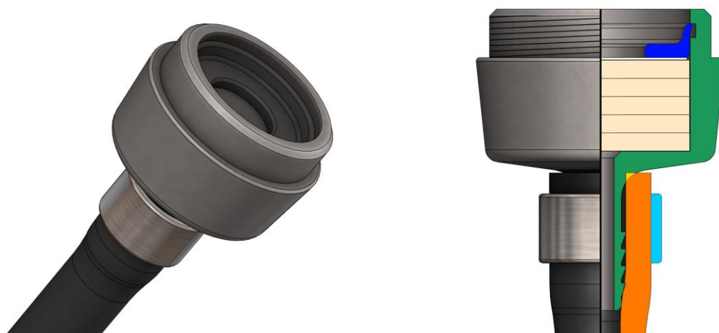
Kuvio 19. Hengitysletkun hengityksensuojaimen puoleinen liitin, perspektiivikuva ja halkaisukuva, molemmat kuvat 3d – mallista.
