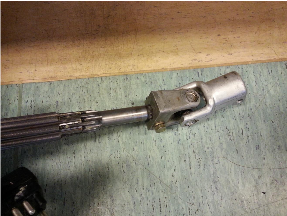
Kuva 5. Ohjausakselin pään kulmanivel (valokuva Arto Pirinen)
