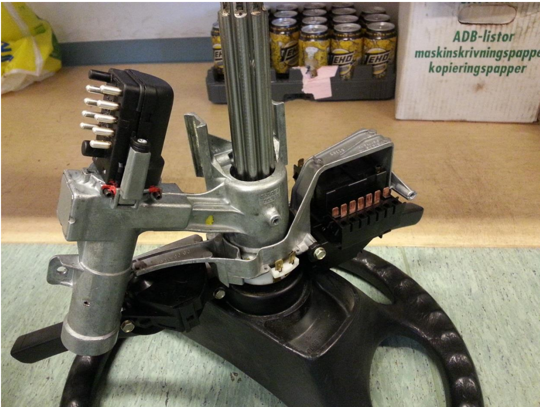
Kuva 4. Auton rattirunko (valokuva Arto Pirinen)
