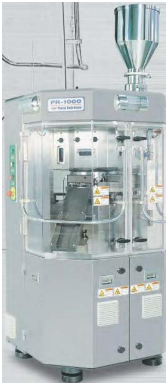
KUVA 5. PR-1000-sarjan tablettipuristin (Pharm Tech Korea).
