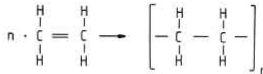
KUVIO 1. Eteenin polymerointi polyeteeniksi (Prosessitekniikka, 2014)
