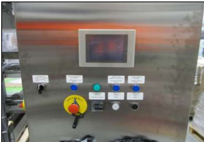
KUVA 10. Sähkökaapin oveen sijoitettu NS5-TQ11-V2-mallin kosketusnäyttö ja koneen käyttöön liittyvät painikkeet ja kytkimet
