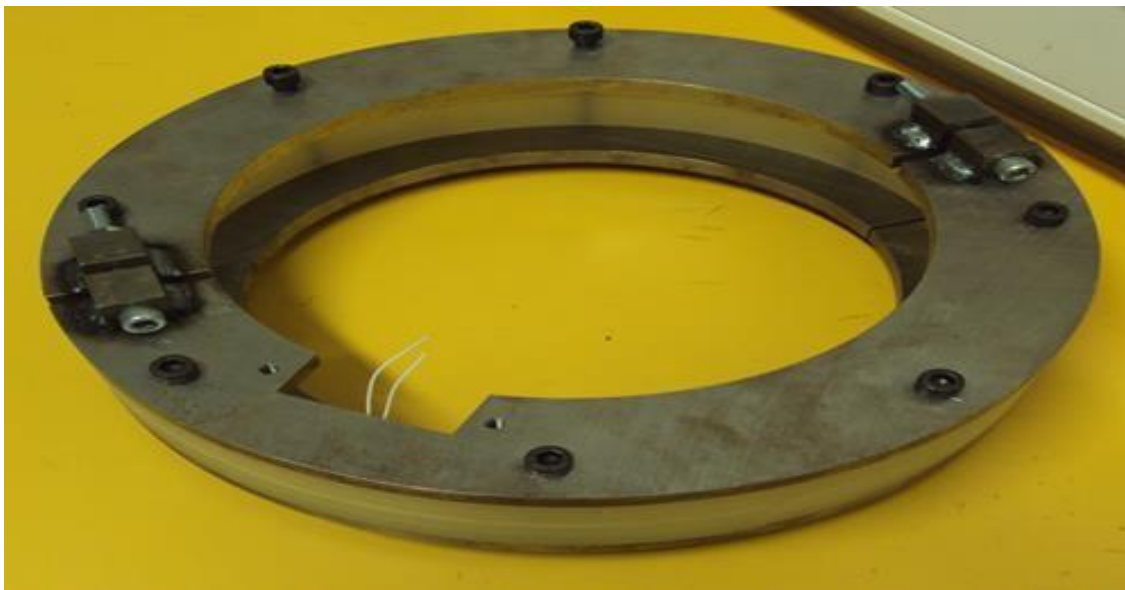
KUVIO 9. Akselin ympärille asennettava teräspanta muovisisustalla. Kuvassa myös antennikäämin päät.
