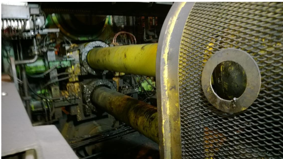
KUVIO 3. Kardaaniakselit valssituolilla F1. Jakovaihteisto ja kytintä suojaava häkki oikealla.
