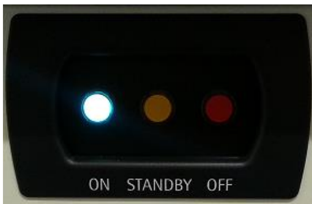
Kuva 35. Sammuta järjestelmä painamalla STANDBY.
