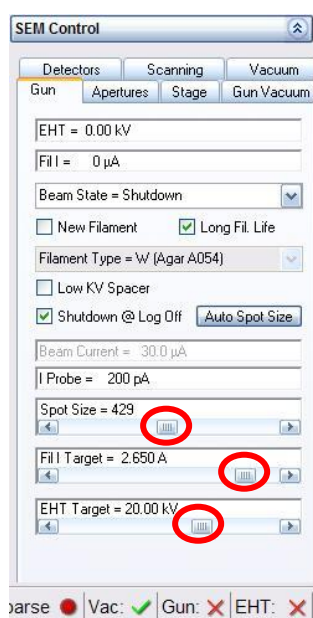
Kuva 22. Aseta arvot I Probe = 200 pA ja EHT Target = 20.00 kV
