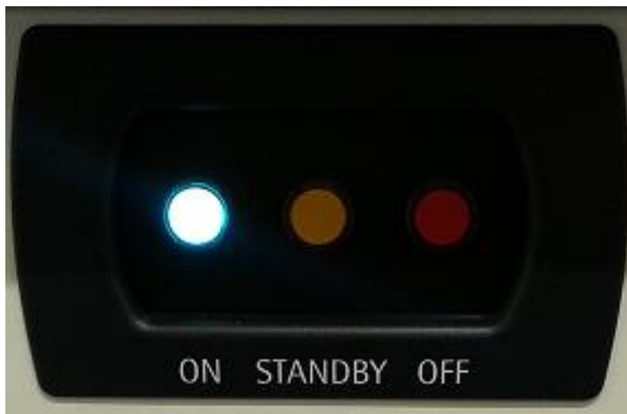
Kuva 1. ON-painike elektronimikroskoopin alapuolella
