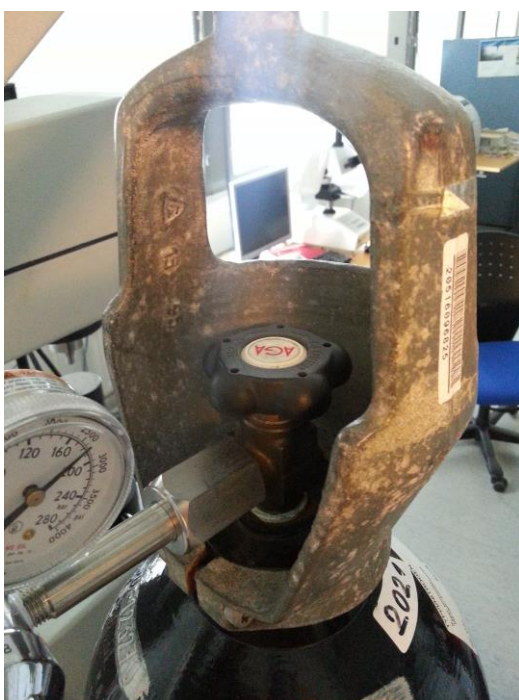
Kuva 10. Tyypipullon pääventtiili aukeaa kiertämällä vastapäivään.
