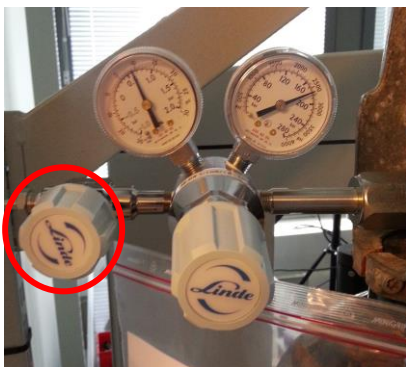
Kuva 33. Avaa typpipullon vasemmanpuoleinen venttiili.
