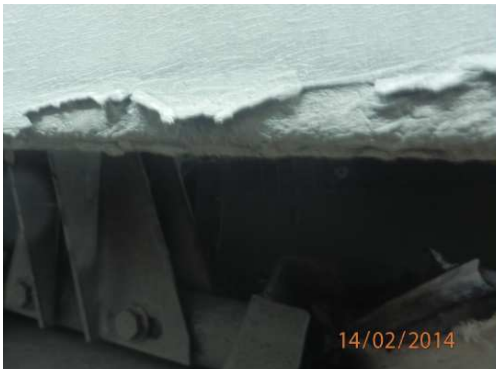
Kuvio 9. Kuumuuden aikaansaama maalipinnan eläminen linja-auton kyljessä (Tähti 2014).
