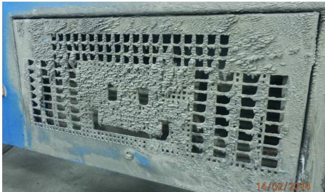
Kuvio 10. Suolan aikaansaama likakovettuma moottorin tuuletusaukon päällä (Tähti 2014).
