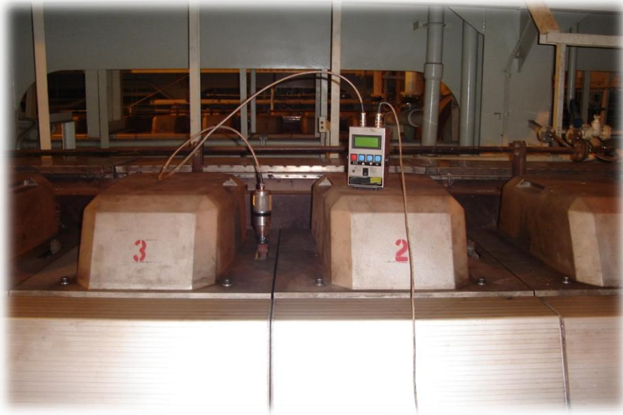
Kuva 3. Premet -mittalaite yhdistettynä indikointiventtiiliin ja kierroslukuanturiin.
