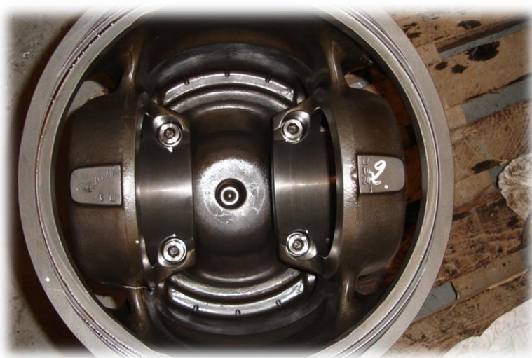
Kuva 14. Männän helma irrotettuna kiertokangesta.
