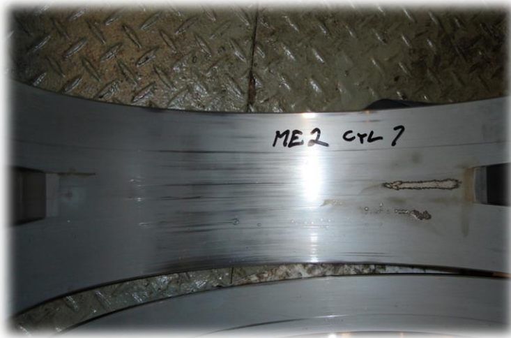
Kuva 23. DG2:n alapään laakeri.
