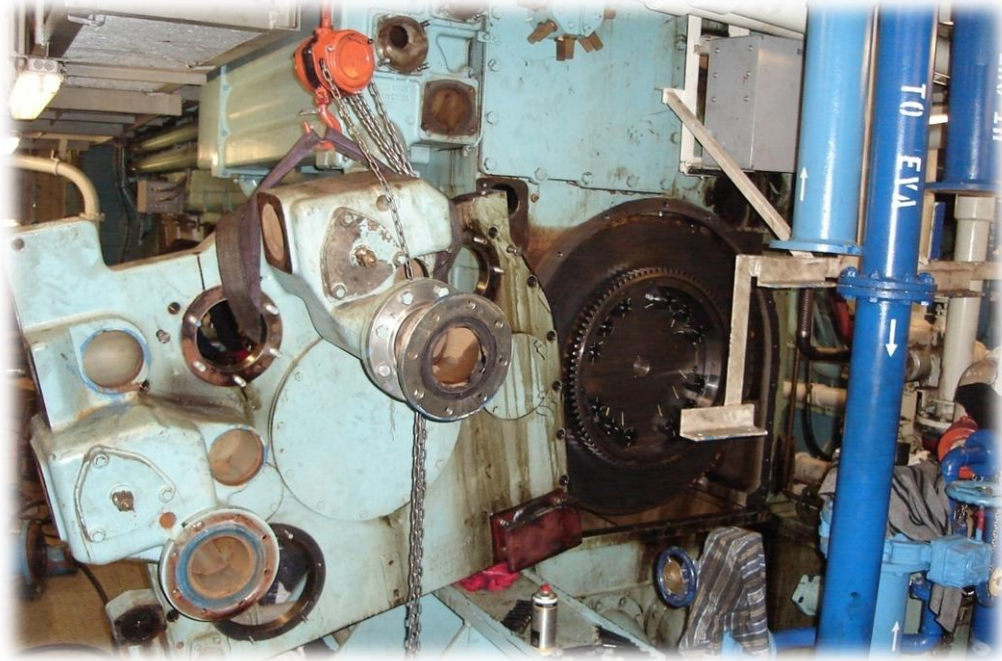
Kuva 34. Tärinänvaimennin näkyvillä moottorin päässä.
