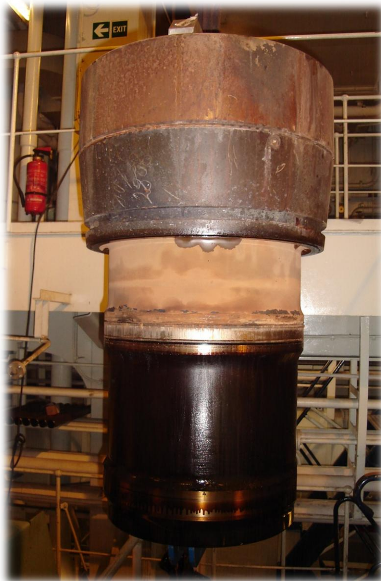
Kuva 15. Sylinterivuori juuri irrotettuna
