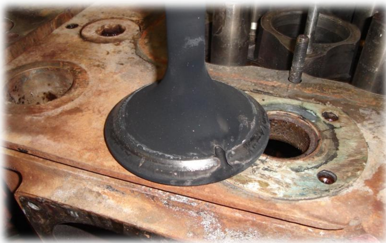
Kuva 8. DG4:n palanut imuventtiili
