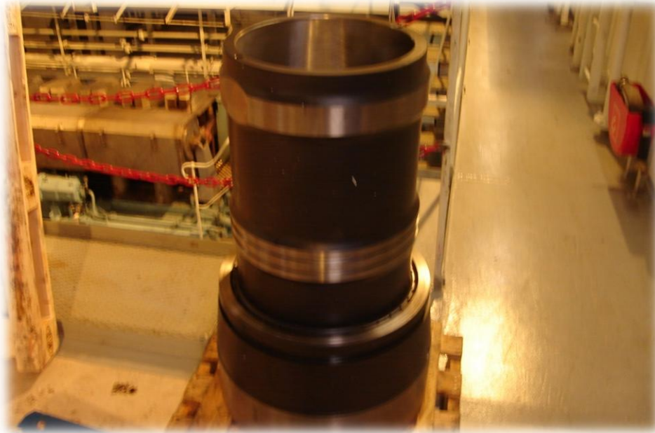
Kuva 16. Sylinterivuori ennen asennusta moottoriin.
