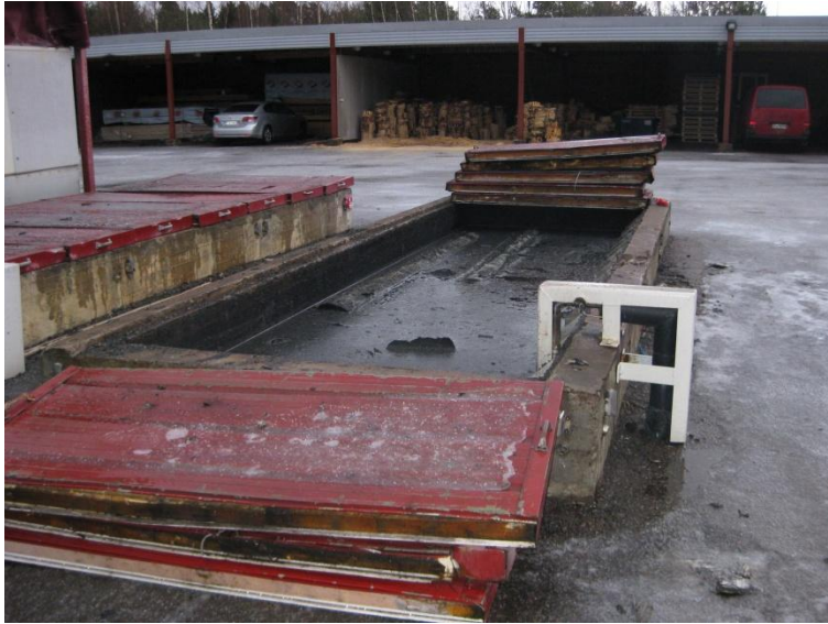
Kuva 1. Tukkien haudonta vesialtaassa, KVT Oy
