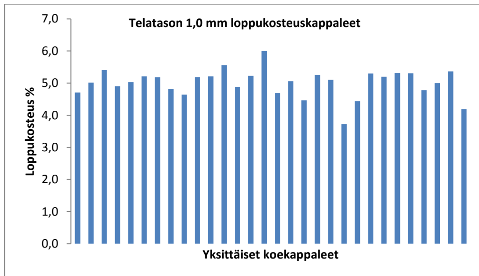
Kuva 22. Telatasolla kuivatuista 1,0 mm:n koeviiluista irrotettujen kuivauksen jälkeisten loppukosteuskoekappaleiden tulokset
