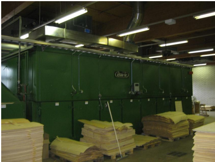
Kuva 7. KVT Oy:n kuivaajan kuumaosa
