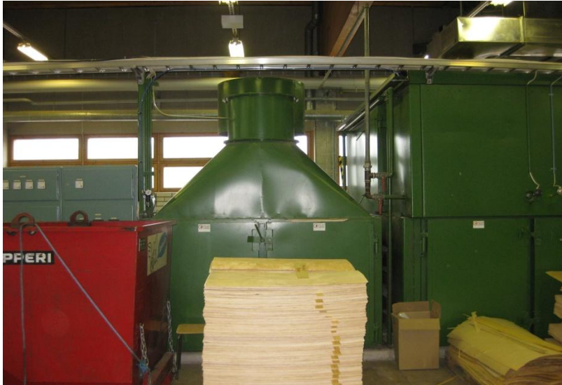
Kuva 8. KVT Oy:n viilunkuivaajan jäähdytysosa
