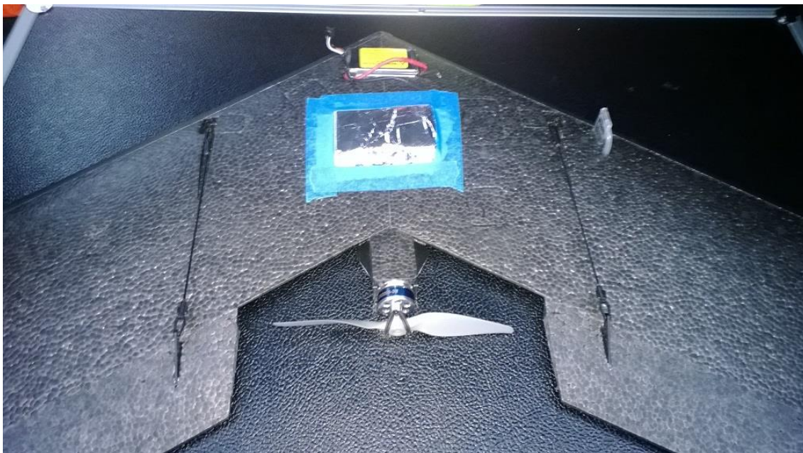
Kuva 12. Lennokin kameran suojaus alumiinifoliolla. Kuva: Ilkka Partonen.
