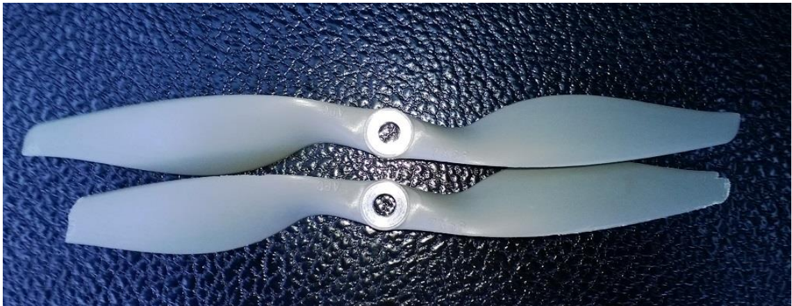
Kuva 11. Lennokin uusi (yllä) ja vaurioitunut (alla) potkuri. Kuva: Ilkka Partonen.
