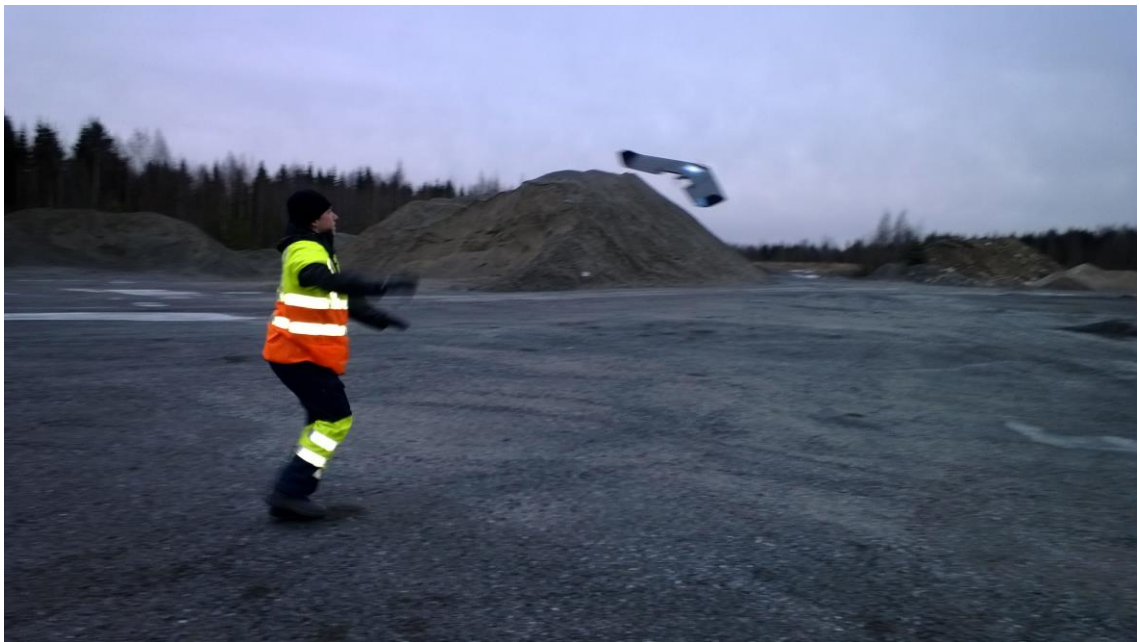
Kuva 9. Senseflyn swinglet CAM -lennokin lähetys kuvausalueella. Kuva: Ilkka Partonen.
