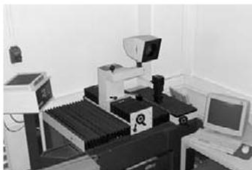
Ääriiviiprojektorilla varustettu työkalujen esiasetuslaite. (KM)
