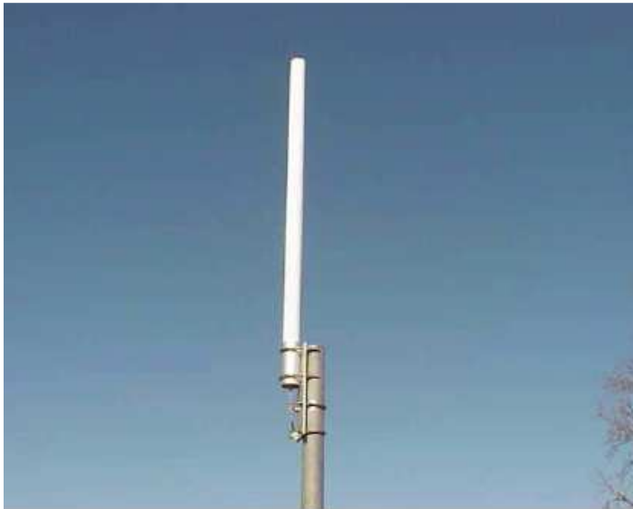
Kuva 21. Ympärisäteilevällä antennilla saadaan lisätehoa.
