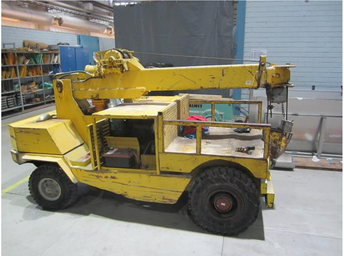
Kuva 3.3. Päältä ajettava Grove Stevedore 4000 –nosturi, jossa on teleskooppipuomi, jonka päässä olevalla koukulla voi nostaa pystysuunnassa
