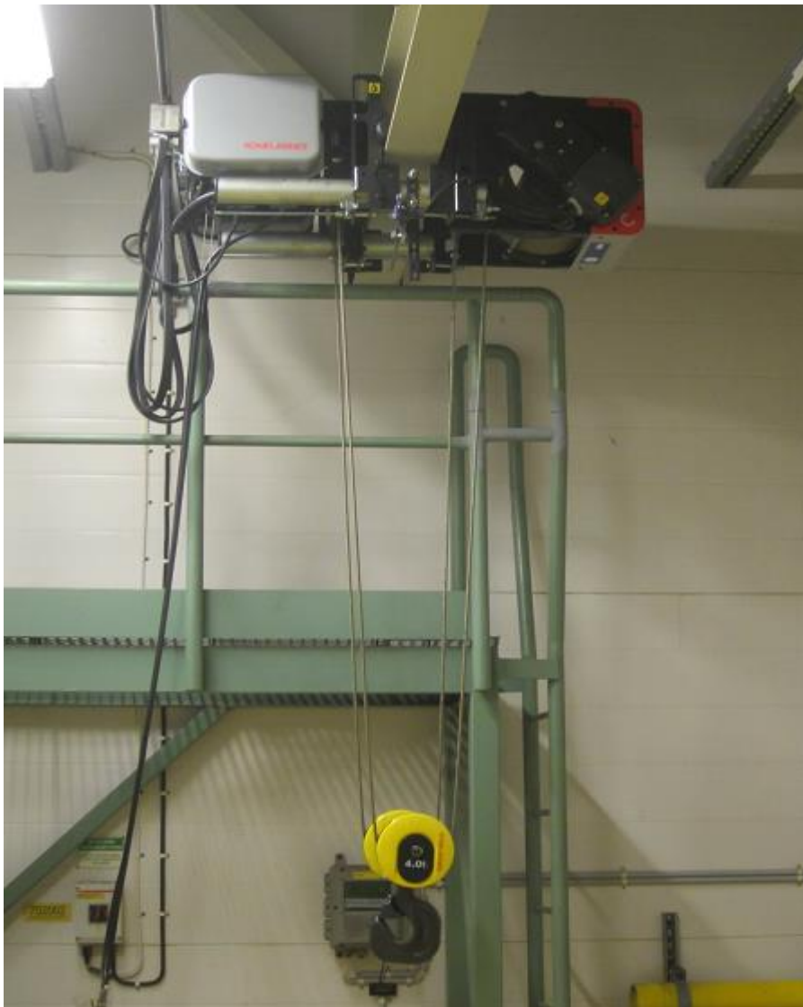
Kuva 9.6. Klooripullojen huoltonostin, jonka koukussa näkyy väärä merkintä 4.0t (nostoraja 4000 kilogrammaa)
