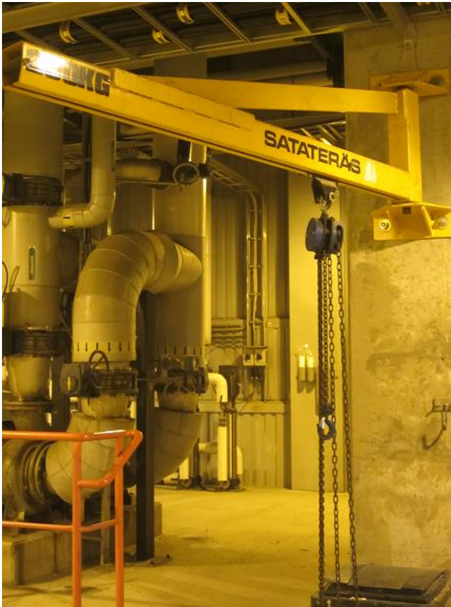
Kuva 9.11. Käsikäyttöinen väljän ritilän ketjunostin 822017
