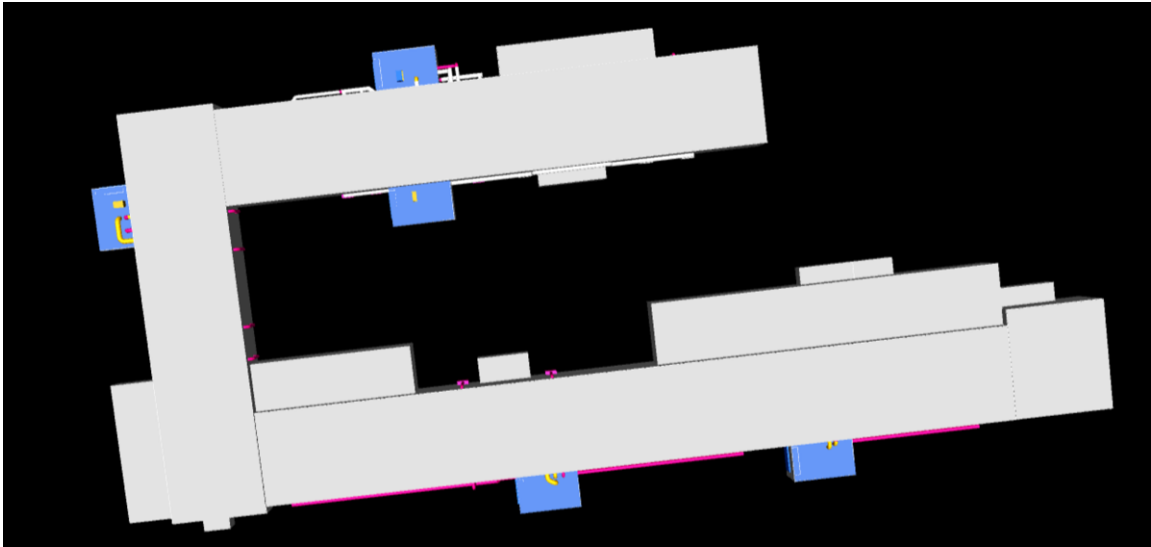
KUVA 11. IFC-malli putkitehtaasta, uusien IV-konehuoneiden ehdotetut sijainnit värjätty sinisellä.
