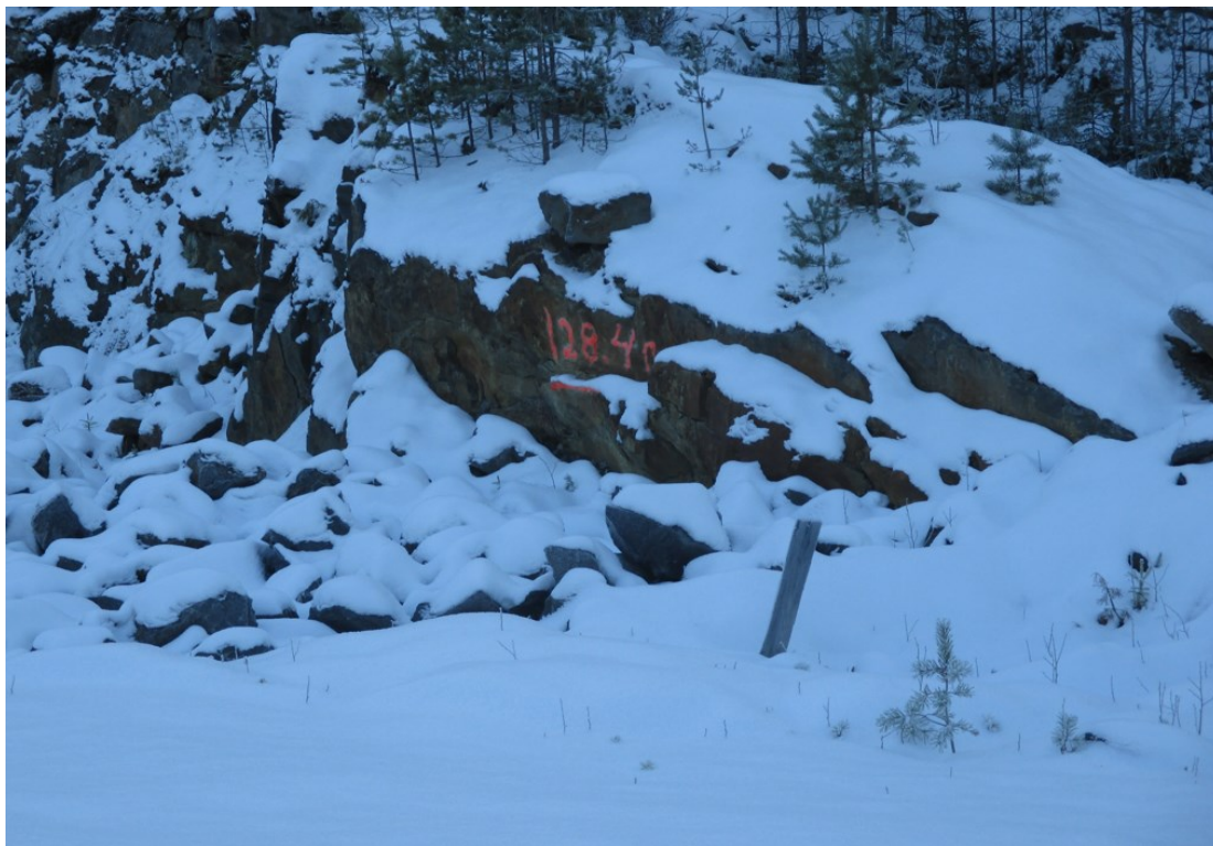
KUVA 6. Korkomerkki kalliossa (Kainulainen 2019)
