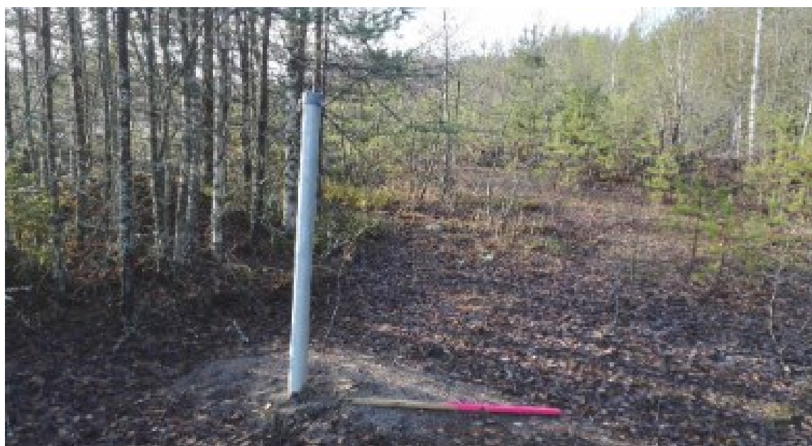
KUVA 3. Pohjaveden tarkkailuputki (Turunen 2020a)
