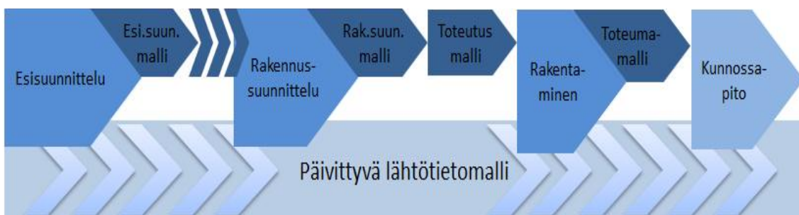
KUVA 7. Lähtötietomalli osana hankkeen elinkaarta. Päivittyvä lähtötietomalli siirtyy tavoitetilassa suunnitteluvaiheesta toiseen (PRE/inframallin vaatimukset ja ohjeet, Osa 3.0 Lähtötiedot. 2014, 4)
