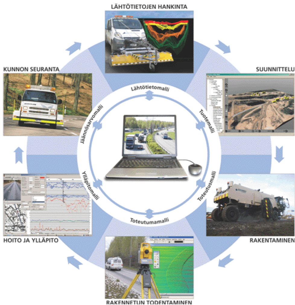
KUVA 1. Tietomallin elinkaari infrahankkeessa (Rakennustietosäätiön infraBIM-internetsivut)
