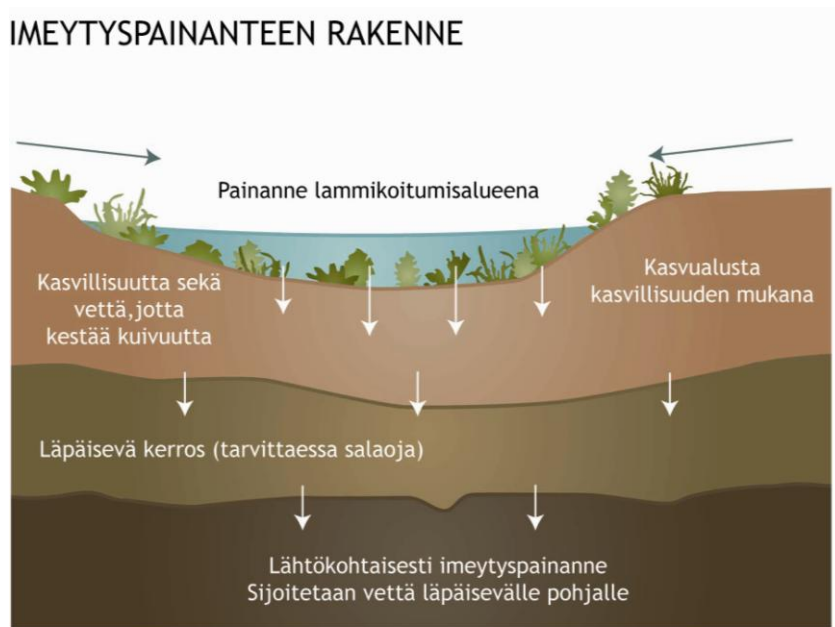
Kuva 10. Imeytysrainanteen rakenne. Kuvan on piirtänyt Jenni Hautamäki lähteen Ahponen 2003 mukaan.
