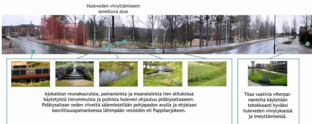
Kuva 28. Kyröskosken keskustan hulevesien varastointiin ja viivyttämiseen soveltuva alue ja soveltuvat tekniset ratkaisut. Kuva Jenni Hautamäki.
