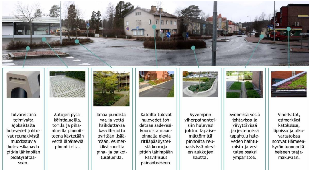
Kuva 27. Kyröskosken keskustan tiiviisti rakennettu tulvariskialue ja siihen ehdotetut luonnollisen huleveden käsittelyn keinot. Kuva Jenni Hautamäki.
