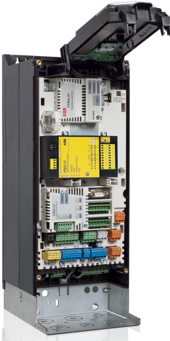
Kuva 4. ACS880-01-taajuusmuuttaja ilman koteloä. Liitettynä FPBA-01-PROFIBUS-kenttäväylämoduuli, FSO-11-turvamoduuli ja FEN31-enkooderi.
