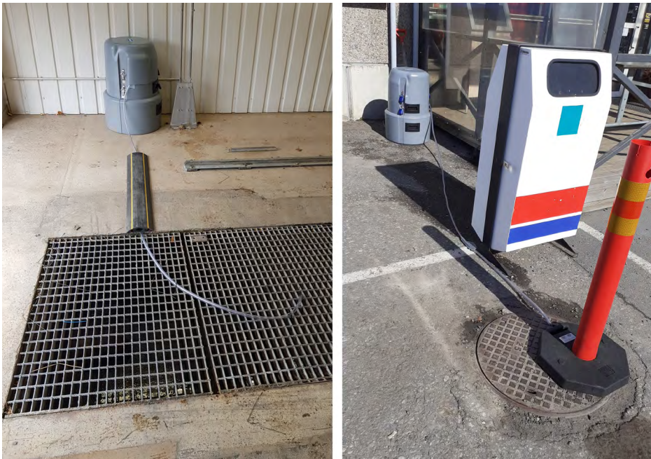
Kuva 3. Näytteenottimien sijainti pesulahallissa ja öljynerotuskaivossa (kuva Mirka Viitala).
