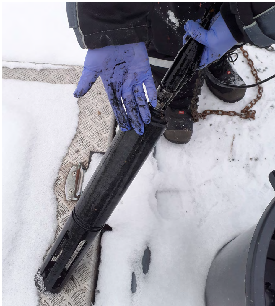
Kuva 10. Sondin pintaan kertynyttä mustaa likaa (kuva Lasse Hämäläinen).
