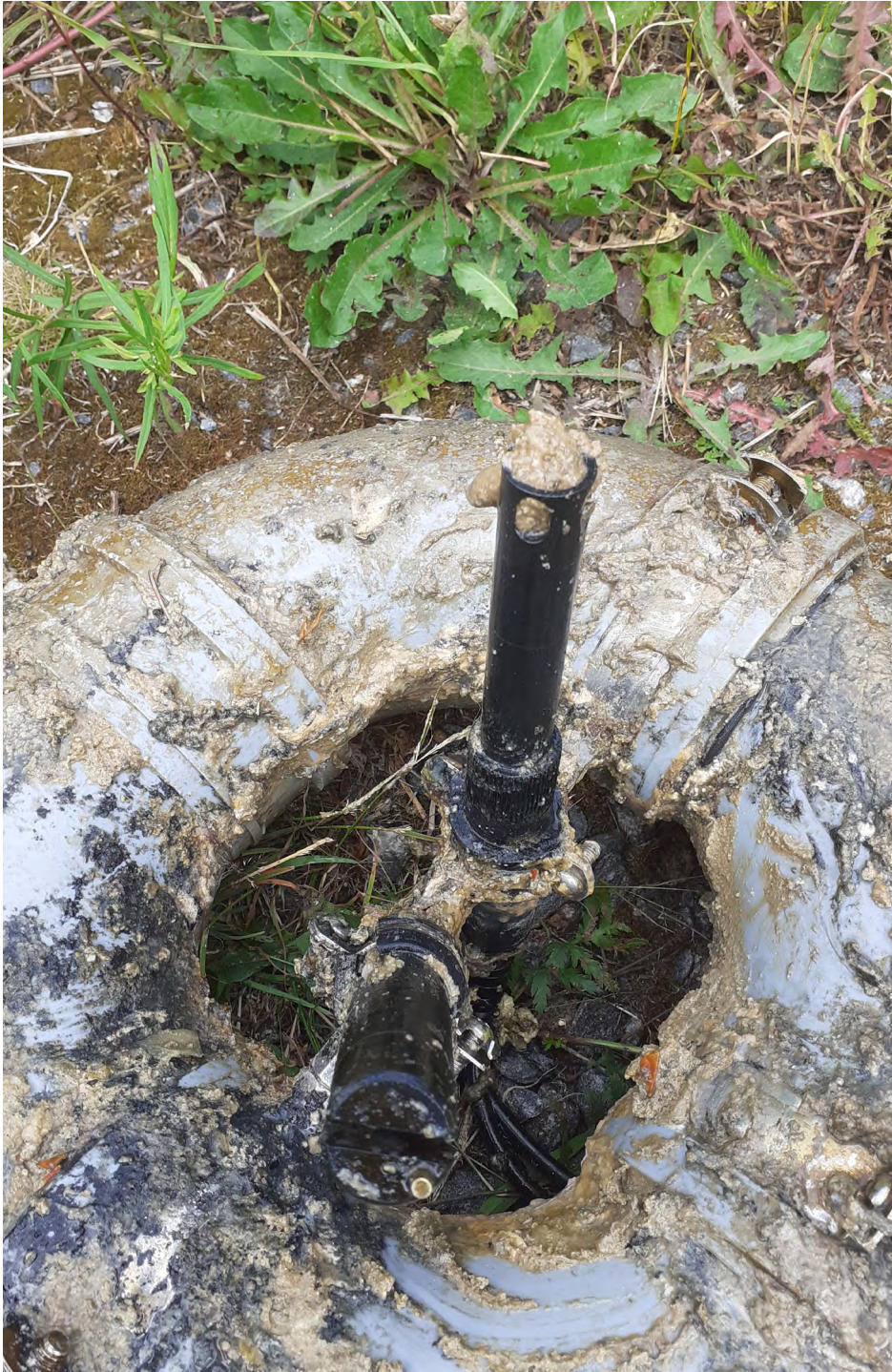
Kuva 1. Rasvainen sakka tukki monitorointilaitteen antureita (kuva Lasse Hämäläinen).
