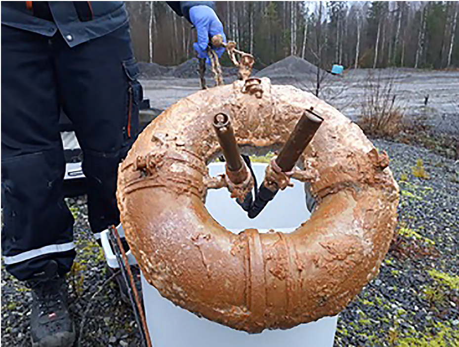
Kuva 5. Mittalaitteistoon kertynyttä rautasakkaa (kuva Lasse Hämäläinen).
