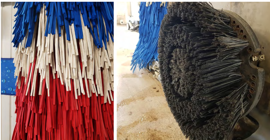
Kuva 1. Autopesulan pesuharjoja, joiden harjakset ovat erivärisiä PE-muoveja (kuvat Mirka Viitala).
