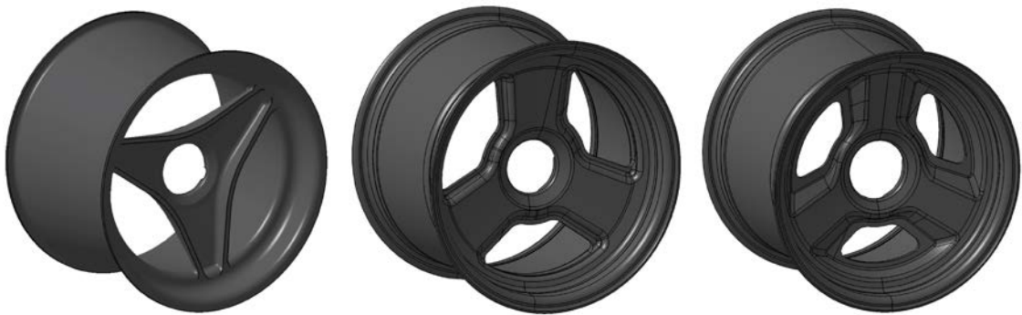
Kuva 8. Vanteen kehitysvaiheita: ensimmäinen hahmotelma - kehitetty ja valittu konsepti - viimeistely vannegeometria yksityiskohdin.
