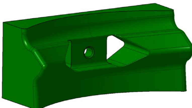
Kuva 30. Puolan sisämuotin ulosvetotyökalu.
