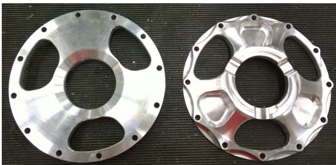
Kuva 31. Alumiinikeskiö koneistuksen jälkeen.
