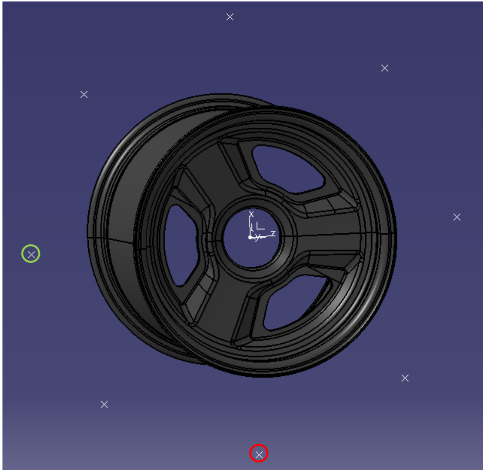
Kuva 17. Koelaskentoihin käytetyt renkaan kontaktipisteet, joista ympyröidyt valittiin lopullisiin laskentoihin.
