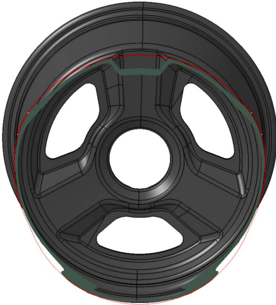
Kuva 7. Rengasasennuksen arviointiin käytetty kuvio. Kuvio jäljittelee renkaan asentoa vanteen yli asennuksen aikana, kun punaisen viiva on suurin piirtein renkaan nimellishalkaisijasta lasketun piirin mittainen (798mm).
