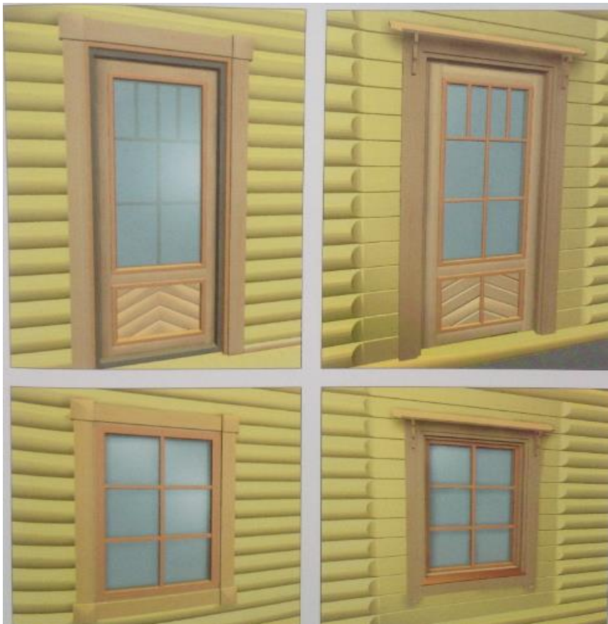
Kuva 23. Erilaisilla pielirakenteilla ja vuorilaudoilla toteutettuja ratkaisuja. [18, s. 117.]
