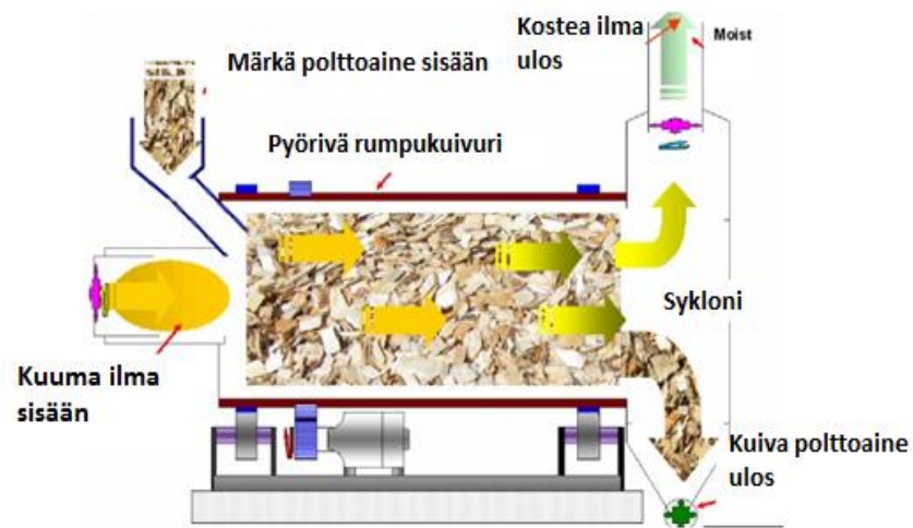
Kuva 12. Jatkuvatoimisen rumpukuivurin periaatekuva (10.)
