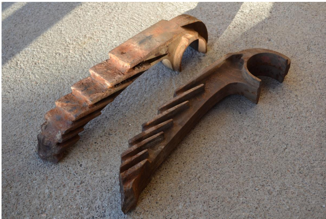
KUVA 2. Kuvassa käytöstä poistettuja mekaanisen viistoarinan arinarautoja. Kuvista näkee raudan porrasmaisen muodon sekä primääri-ilma-aukot.
