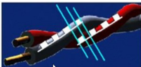
KUVA 4. Parikaapeli (Halttunen s. a)
